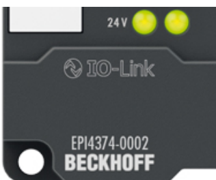
Abb. 10: Status-LEDs für die Spannungsversorgung
