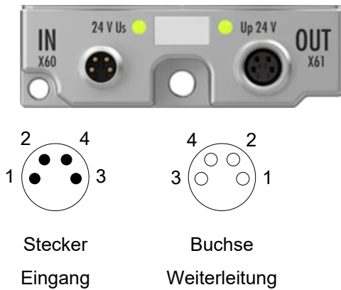
Abb. 5: M8-Steckverbinder
