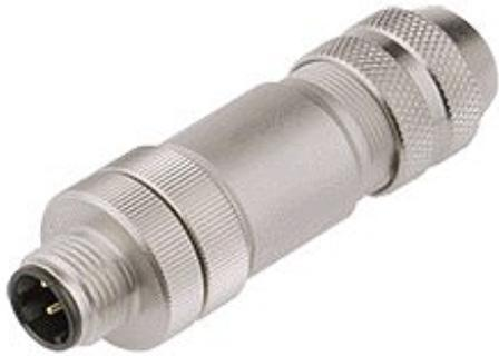
附图 25: M12 连接器, 4 针, IP67, 适用于现场组装, D 型编码
