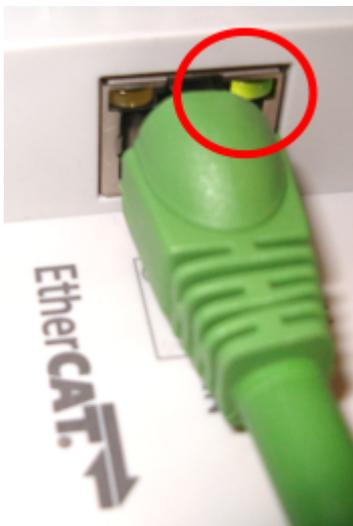
附图 33：以太网设备上的链路 LED
