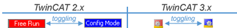
Abb. 92: Anzeige des Wechsels zwischen „Free Run“ und „Config Mode“ unten rechts in der Statusleiste
