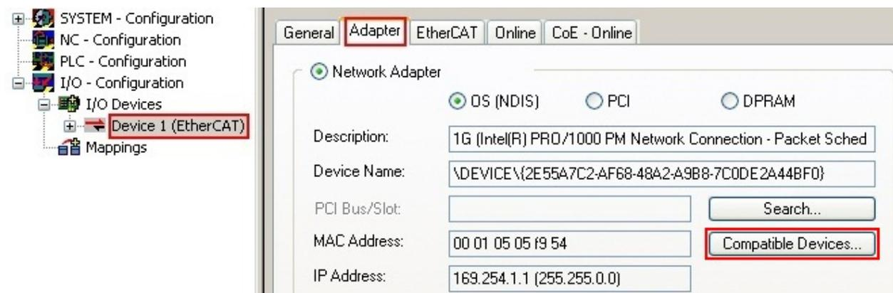
附图 76: EtherCAT设备属性（TwinCAT 2）：点击“适配器”选项卡的“兼容设备...”
