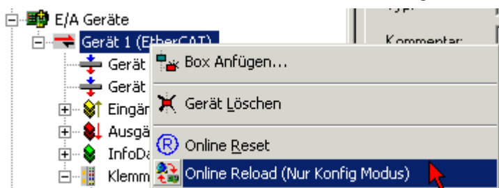
Abb. 16: Selektiver Reload des EtherCAT Gerätes
