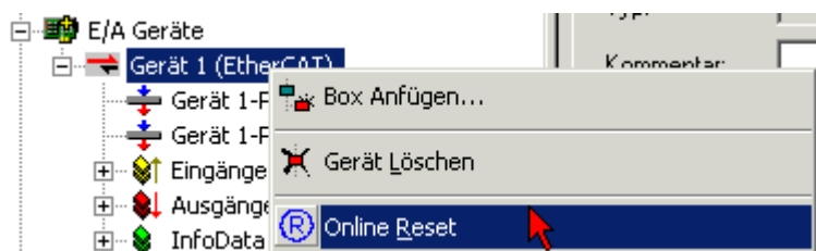
Abb. 13: Selektiver Reset eines konfigurierten Gerätes
