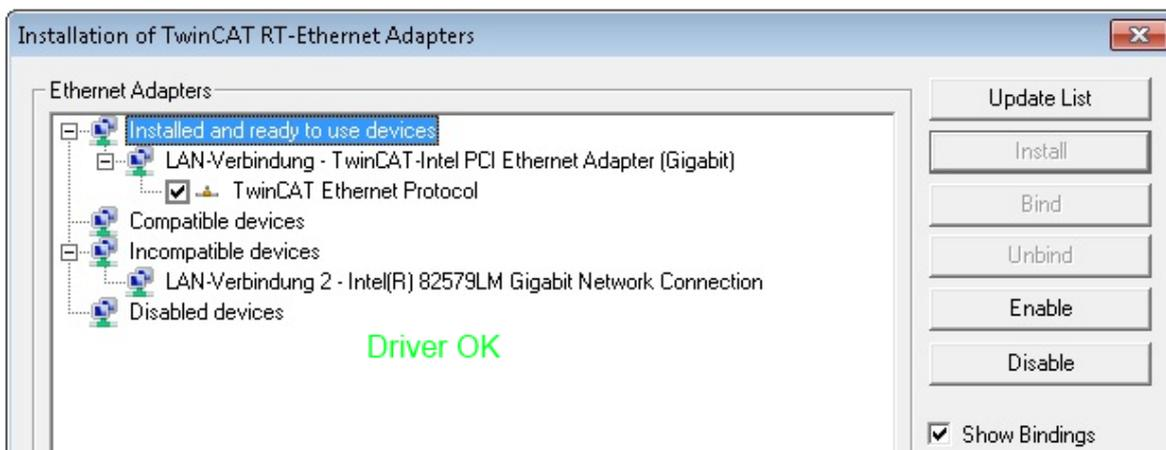
図 67: イーサネットポートに対する正しいドライバ設定の例
