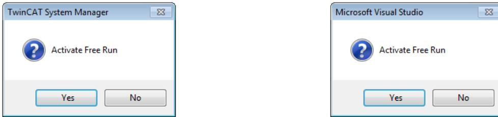
図 96: Config/FreeRun確認ダイアログ(左: TwinCAT 2、右: TwinCAT 3)
