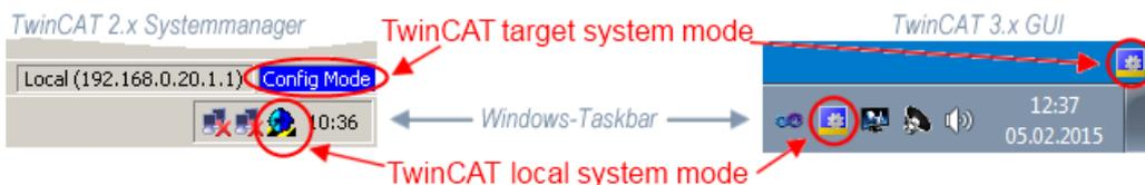
図 86: ローカルシステムとターゲットシステムの違い(左: TwinCAT 2、右: TwinCAT 3)
