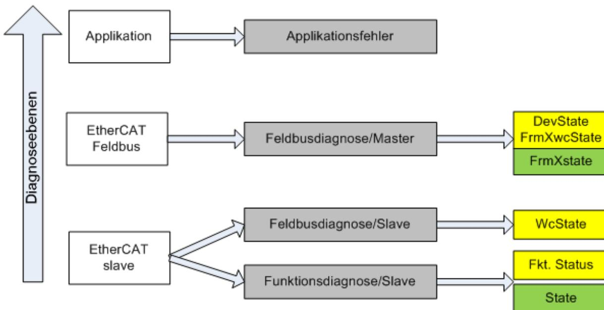
Abb. 124: Auswahl an Diagnoseinformationen eines EtherCAT Slave
