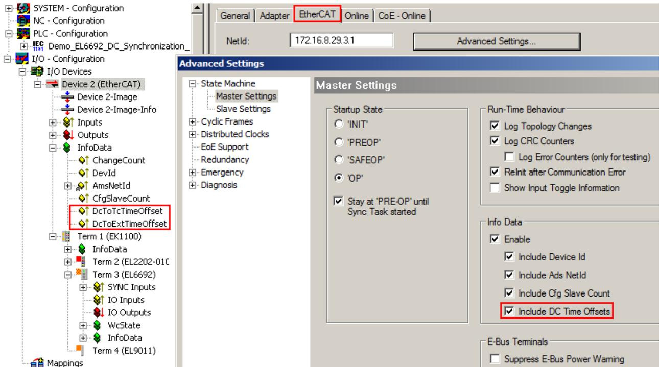
Abb. 163: Anzeige der DC Offsets im EtherCAT Master aktivieren, können auf der Master Seite ausgewertet werden
