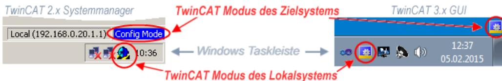
Abb. 93: Unterscheidung Lokalsystem/ Zielsystem (links: TwinCAT 2; rechts: TwinCAT 3)
