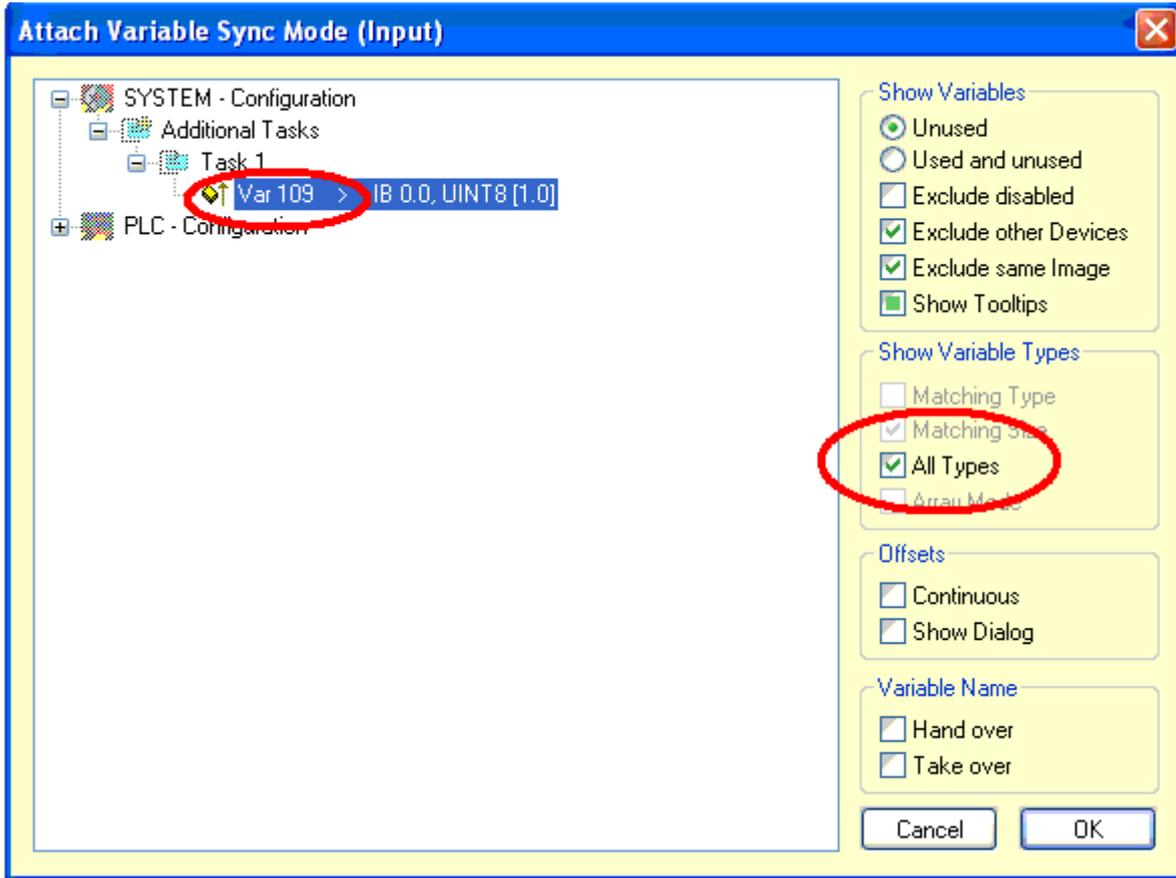
Abb. 150: Definition einer Variablen vom Typ Byte zum verlinken
