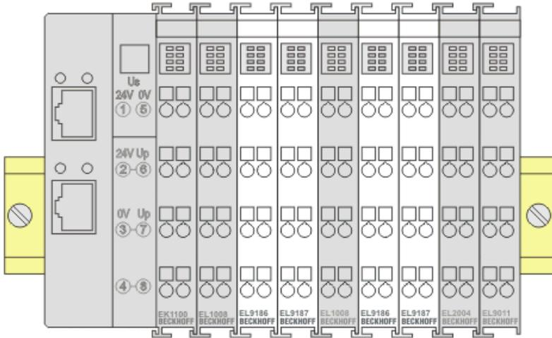
Abb. 19: Korrekte Positionierung
