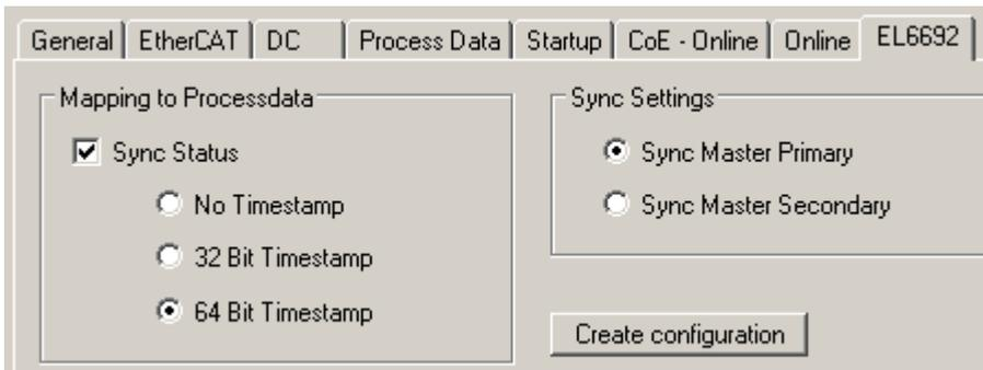
Abb. 162: Synchronisierungsrichtung auf der PrimarySide einstellen, hier SyncSettings: Primary -> Secondary
