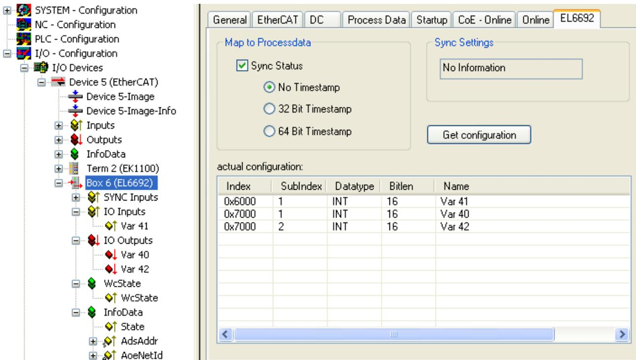
Abb. 140: „Get configuration“ auf der Sekundärseite
