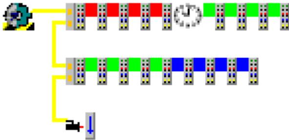
Abb. 5: Einfache I/O-Topologie
