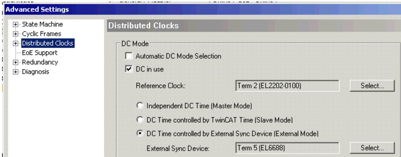
Abb. 8: TwinCAT 2.11 Distributed Clocks Settings - Beispiel für EL6688 im PTP-Slave-Modus als Zeitreferenz für das lokale EtherCAT-System
