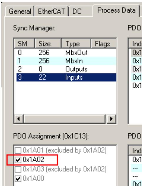
Abb. 161: PDO 0x1A02 aktivieren zur Darstellung der Zeitstempel
