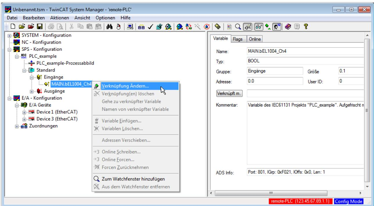
Abb. 38: Erstellen der Verknüpfungen PLC-Variablen zu Prozessobjekten
