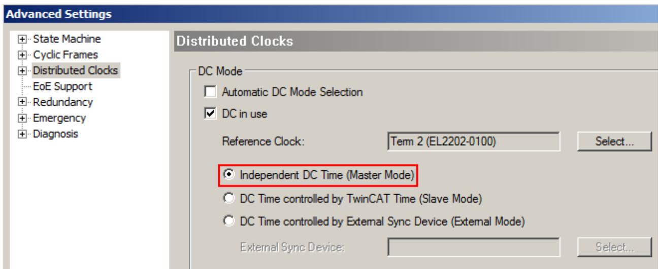
Abb. 164: Master PC arbeitet mit eigener ReferenceClock als Basis
