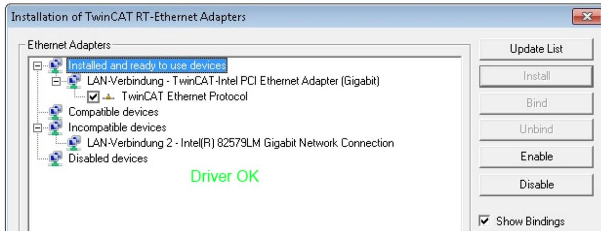
Abb. 72: Beispielhafte korrekte Treiber-Einstellung des Ethernet Ports
