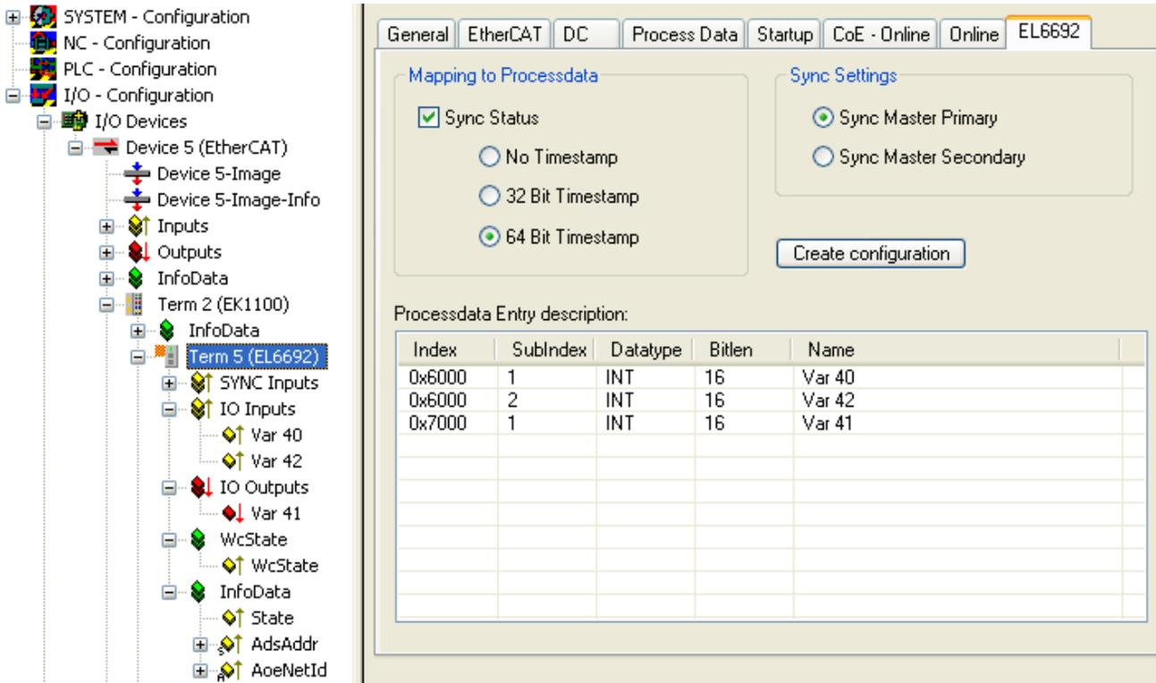
Abb. 139: „Create configuration“ auf der Primärseite
