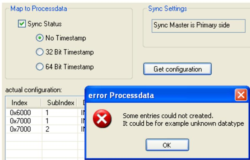
Abb. 142: Warnhinweis bei Verwendung komplexer Datentypen
