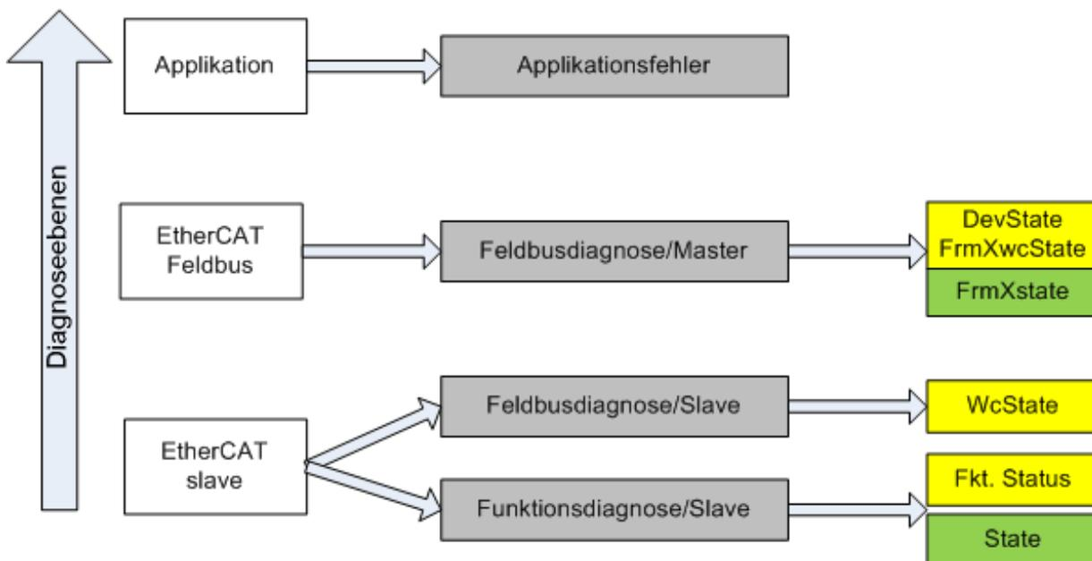
Abb. 115: Auswahl an Diagnoseinformationen eines EtherCAT Slave
