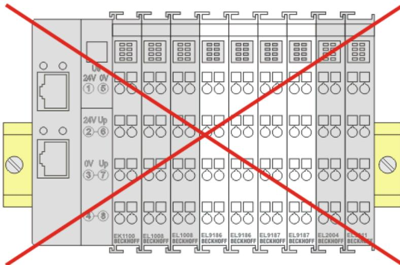
Abb. 16: Inkorrekte Positionierung
