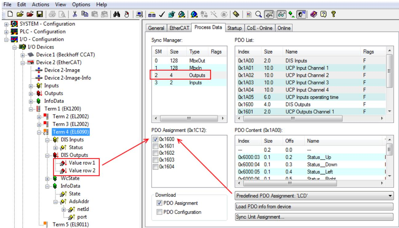
Abb. 127: PDO 0x1600 (Predefined PDO Assignment 'LCD') für die Anzeige der Platzhalter für INT-Variablen
