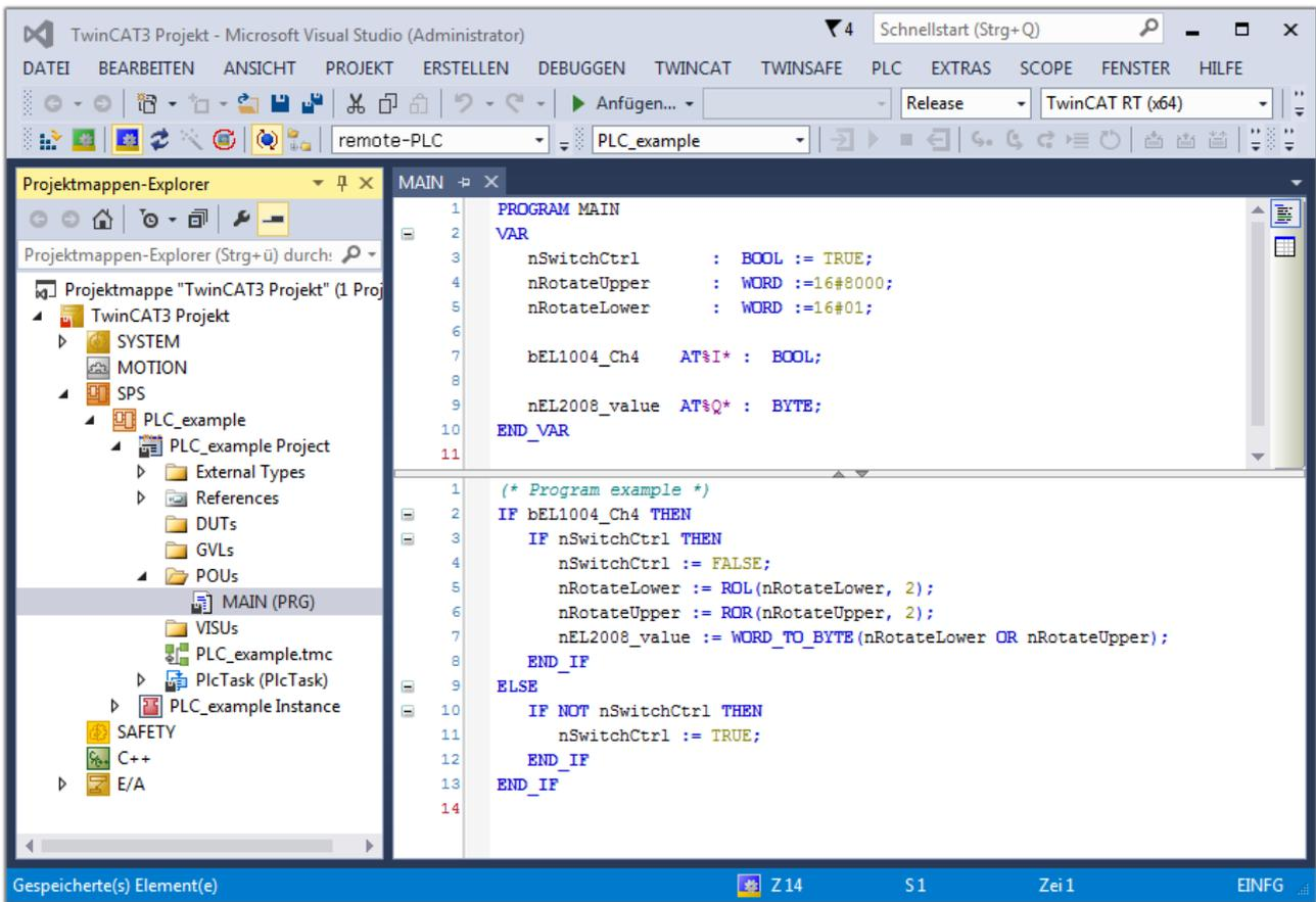
Abb. 48: Beispielprogramm mit Variablen nach einem Kompilervorgang (ohne Variablenanbindung)
