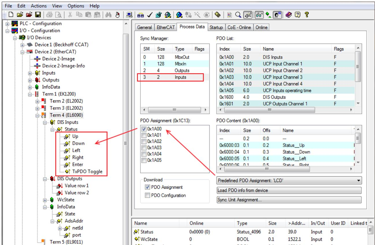
Abb. 126: PDO 0x1A00 (Predefined PDO Assignment 'LCD') zum Ansprechen des NAVI-Schalters
