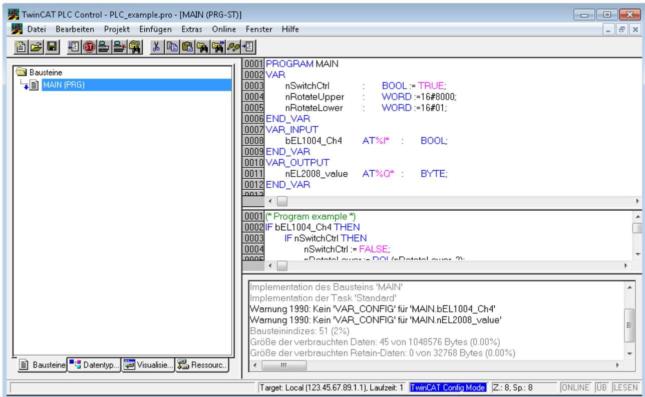
Abb. 27: Beispielprogramm mit Variablen nach einem Kompilervorgang (ohne Variablenanbindung)
