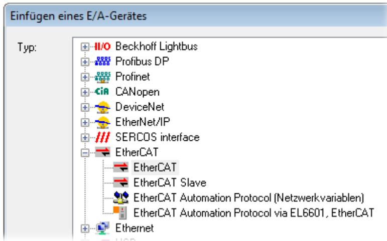
Abb. 75: Auswahl EtherCAT Anschluss (TwinCAT 2.11, TwinCAT 3)
