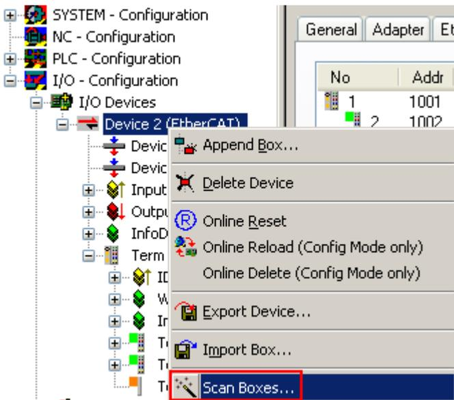
Abb. 134: Rechtsklick auf das EtherCAT Gerät bewirkt das Scannen des unterlegerten Feldes
