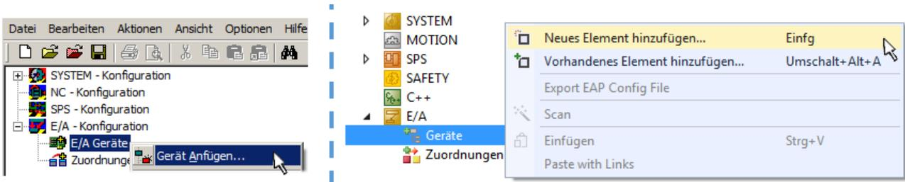
Abb. 74: Anfügen eines EtherCAT Device: links TwinCAT 2; rechts TwinCAT 3
