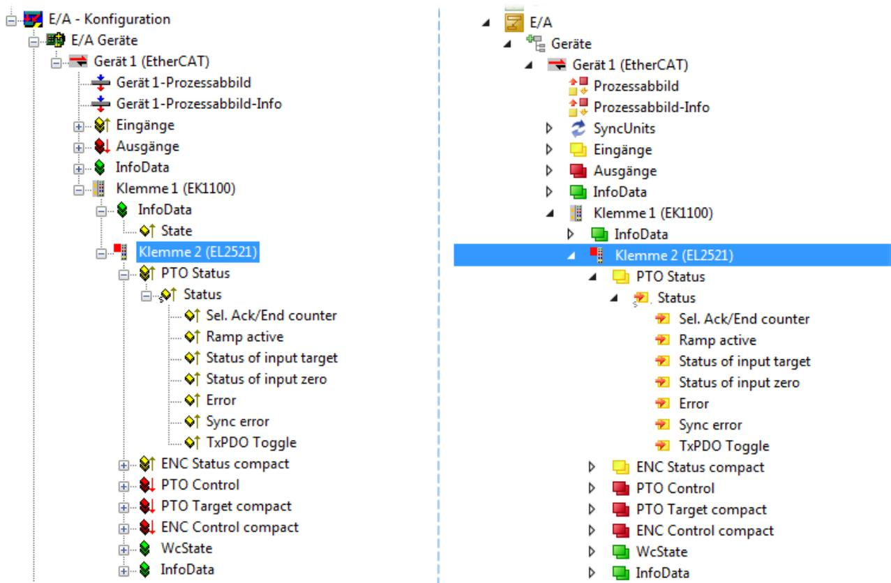
Abb. 83: EtherCAT Klemme im TwinCAT-Baum (links: TwinCAT 2; rechts: TwinCAT 3)
