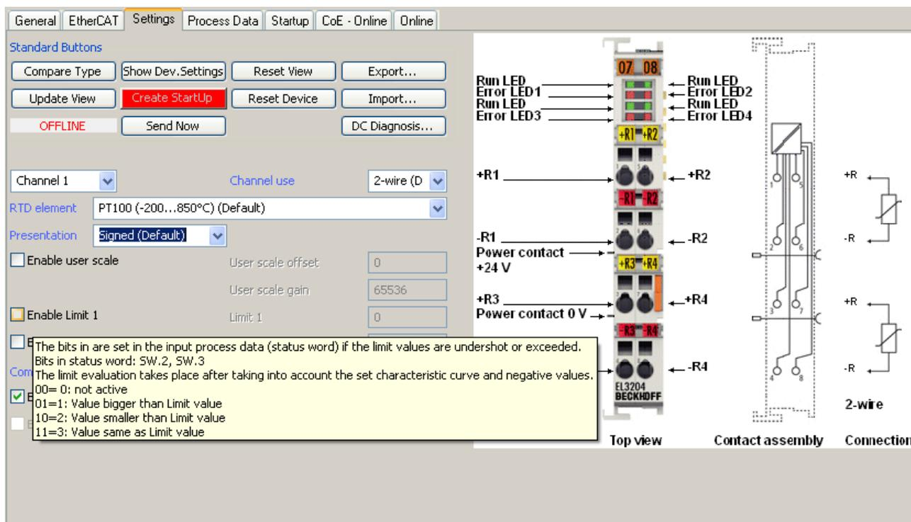
Abb. 118: Beispiel Inbetriebnahmehilfe für eine EL3204
