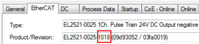
Abb. 89: Einbau EtherCAT-Klemme mit Revision -1018
