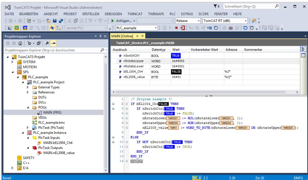
Abb. 58: TwinCAT 3 Entwicklungsumgebung (VS Shell): Logged-in, nach erfolgten Programmstart
