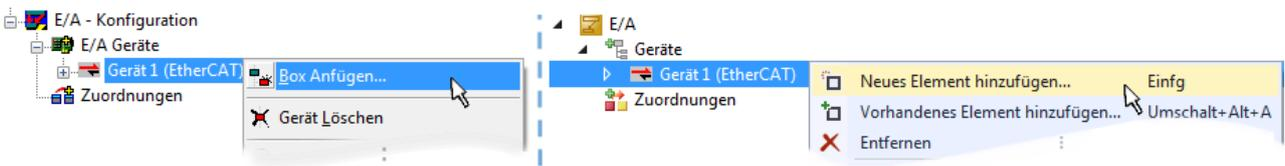
Abb. 78: Anfügen von EtherCAT-Geräten (links: TwinCAT 2; rechts: TwinCAT 3)
