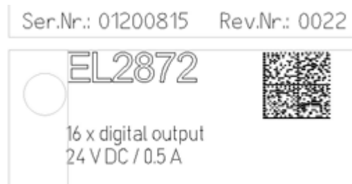
Abb. 1: EL2872 mit Revision 0022 und Seriennummer 01200815
