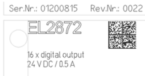
Abb. 1: EL2872 mit Revision 0022 und Seriennummer 01200815
