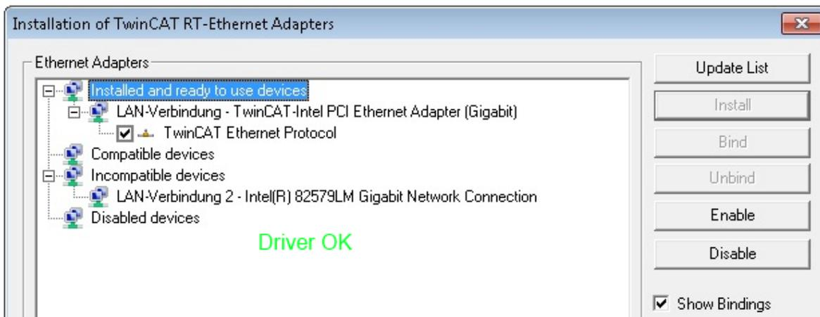
Abb. 118: Beispielhafte korrekte Treiber-Einstellung des Ethernet Ports
