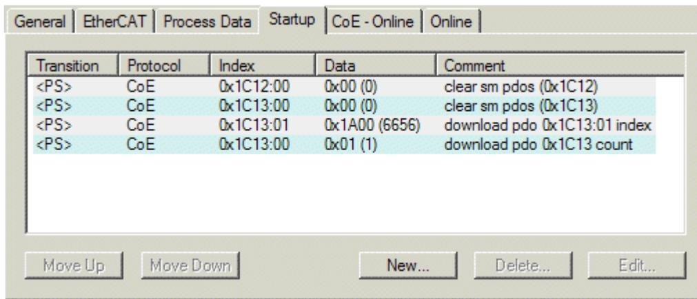
Fig. 144: "Startup" tab
