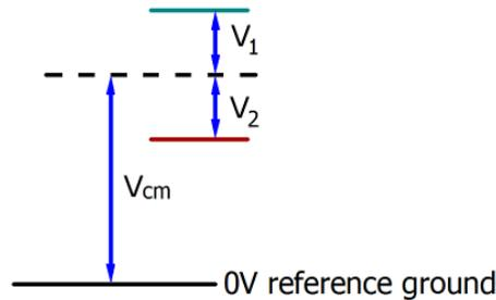
Fig. 187: Common-mode voltage ( $V_{cm}$ )
