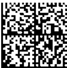
Abb. 3: Beispiel-DMC 1P072222SBTN k4p562d7 1KEL 1809 Q1 51S 678294
