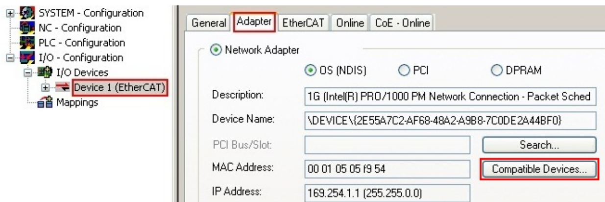
附图 126: EtherCAT 设备属性（TwinCAT 2）：点击“Adapter”选项卡的“Compatible Devices...”
