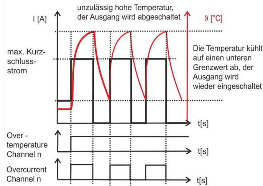
Abb. 16: Schematische Darstellung der thermischen Abschaltung bei Überlast
