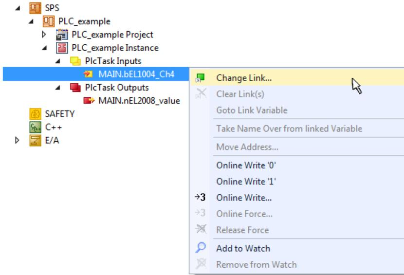
Abb. 81: Erstellen der Verknüpfungen PLC-Variablen zu Prozessobjekten
