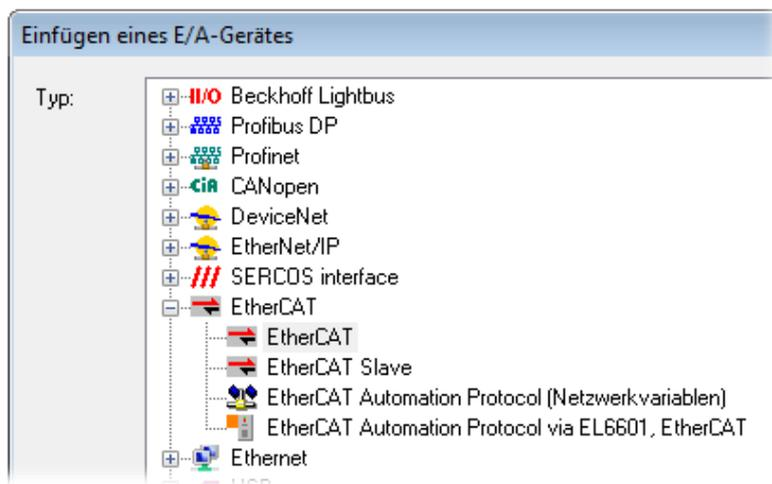
Abb. 108: Auswahl EtherCAT Anschluss (TwinCAT 2.11, TwinCAT 3)
