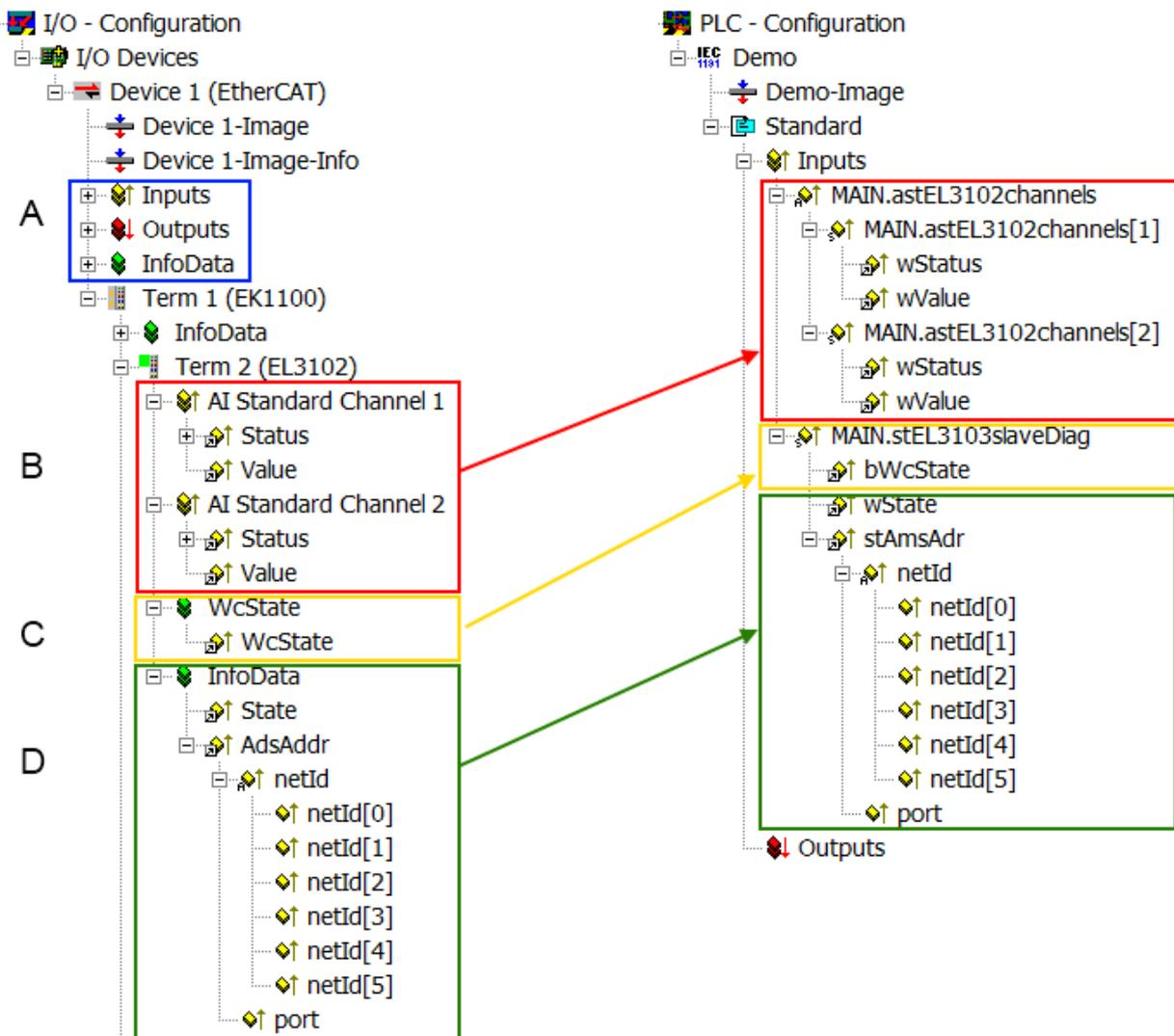
Abb. 149: Grundlegende EtherCAT Slave Diagnose in der PLC
