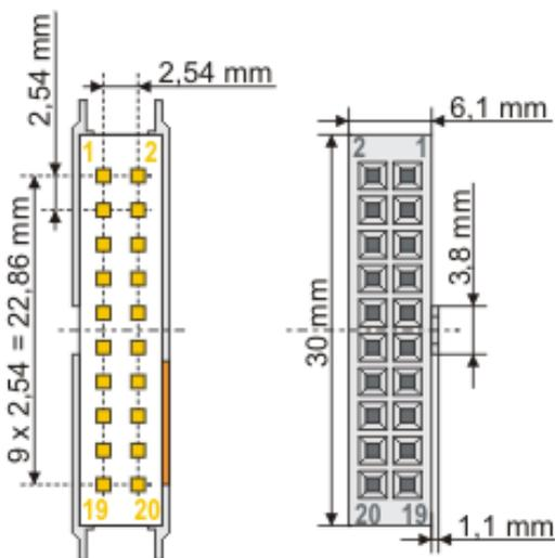
Abb. 26: Abmessungen der 20-poligen Stiftleiste der Klemme und der passenden Federleiste, Beschaltung siehe Konatktbelegung
