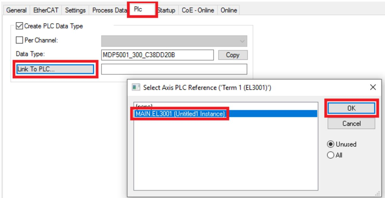
Abb. 87: Verknüpfung der Struktur
