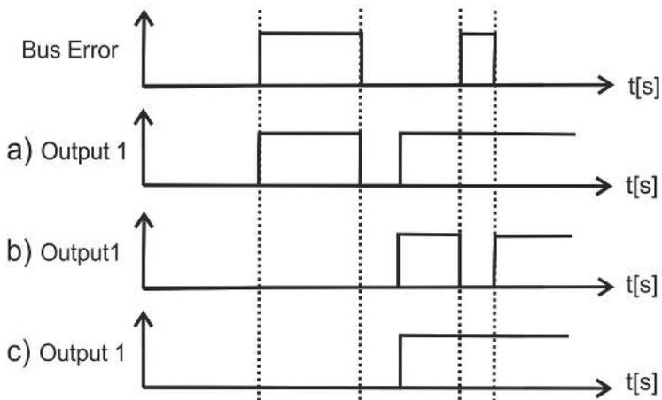
Abb. 23: graphische Darstellung des Kanalzustands bei Busstörung
