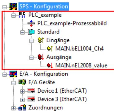
Abb. 60: Eingebundenes PLC-Projekt in der PLC-Konfiguration des System Managers
