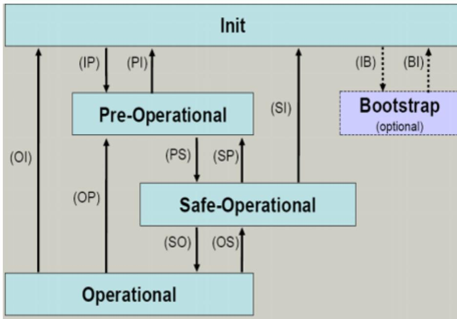
Abb. 31: Zustände der EtherCAT State Machine
