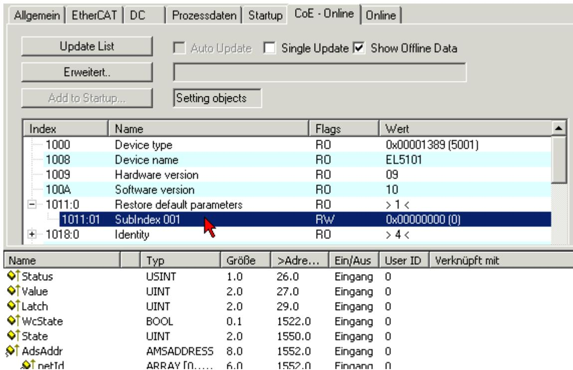
Abb. 169: Auswahl des PDO *Restore default parameters*
