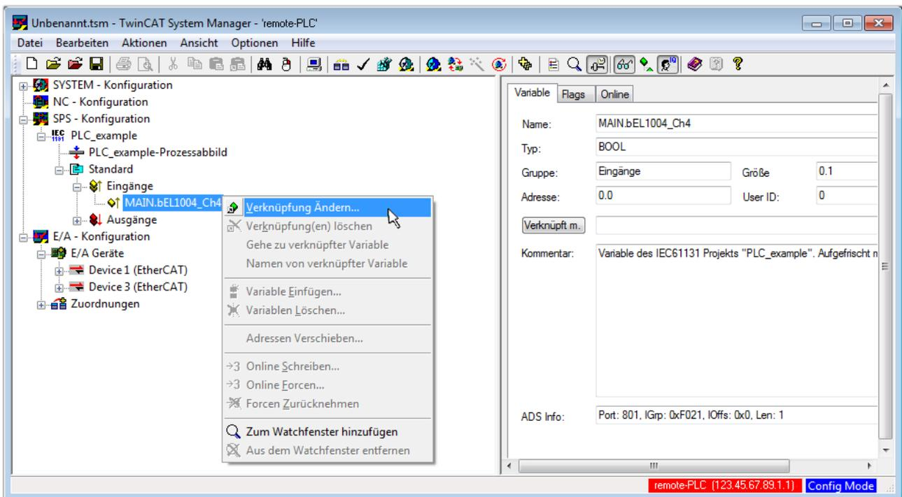
Abb. 61: Erstellen der Verknüpfungen PLC-Variablen zu Prozessobjekten
