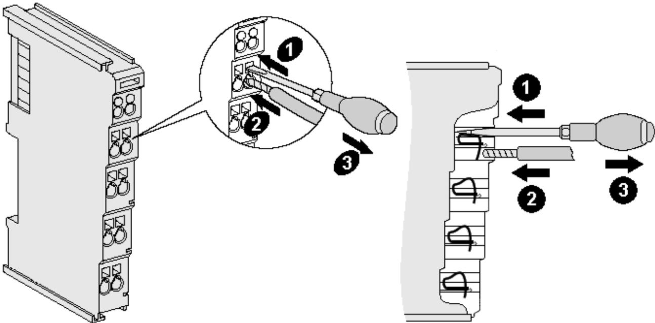
Abb. 43: Anschluss einer Leitung an eine Klemmstelle
