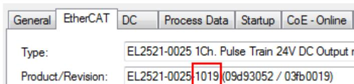
Abb. 123: Erkennen EtherCAT-Klemme mit Revision -1019
