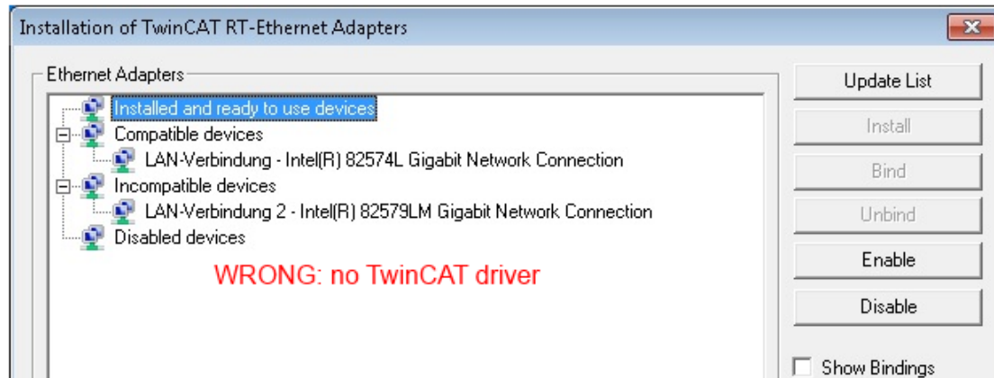
附图 79: 以太网端口驱动程序的错误设置
