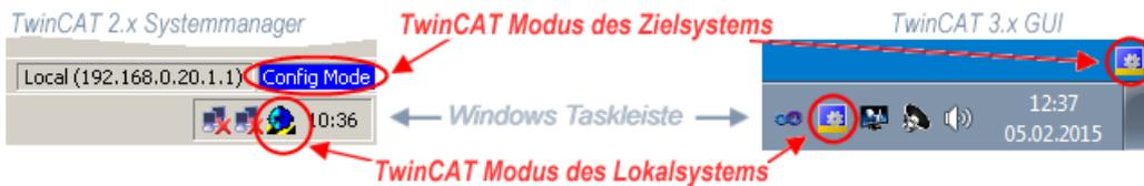
Abb. 106: Unterscheidung Lokalsystem/ Zielsystem (links: TwinCAT 2; rechts: TwinCAT 3)
