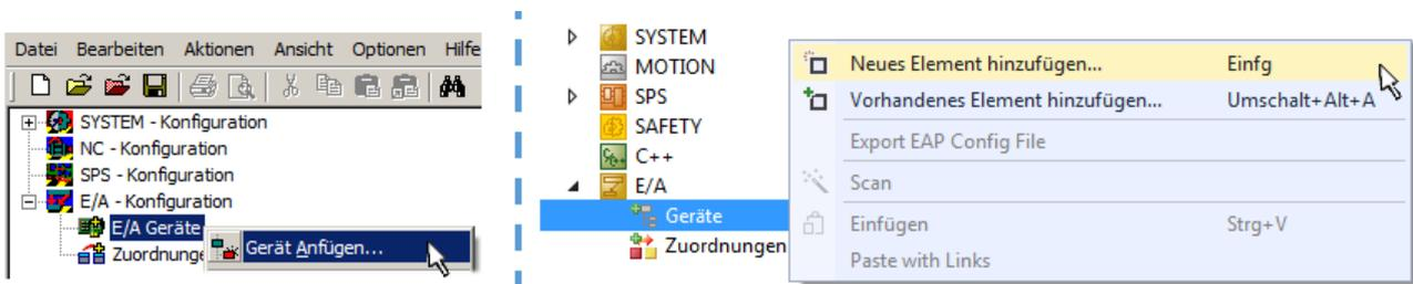
Abb. 96: Anfügen eines EtherCAT Device: links TwinCAT 2; rechts TwinCAT 3
