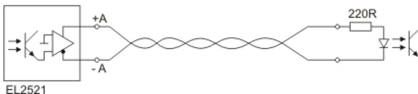
Abb. 26: EL2521, direkter Anschluss an einem Optokoppler
