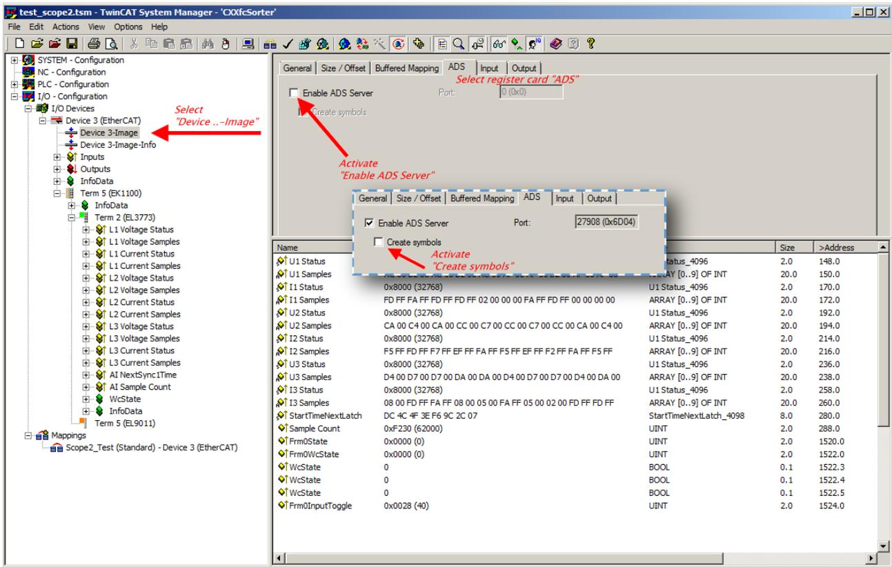
Abb. 160: Aktivierung des ADS Servers des EtherCAT Device (TwinCAT 2)
