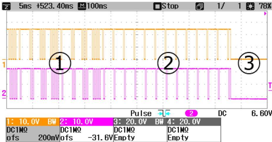
Abb. 166: default Ausgabeverhalten bei deaktivierter CycleCounter-Überwachung
