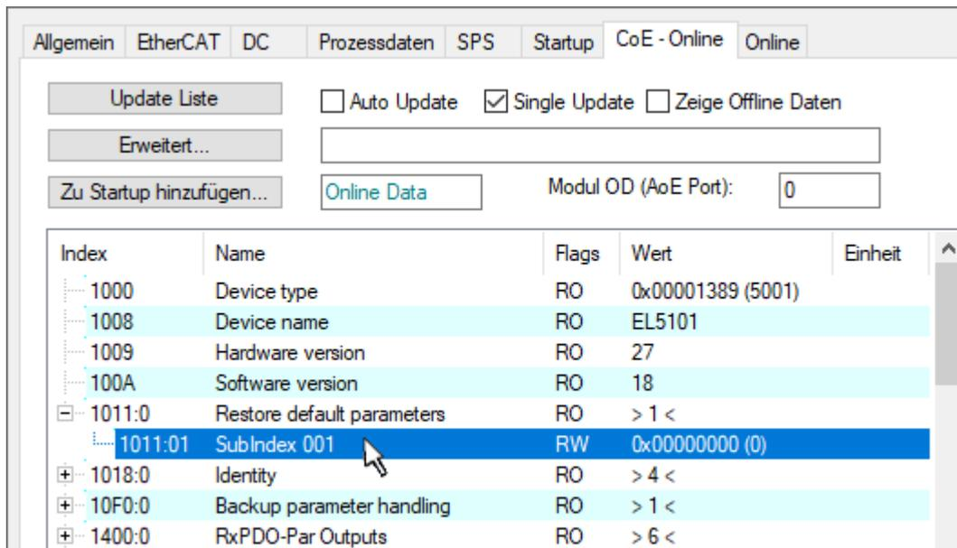
Abb. 194: Auswahl des PDO *Restore default parameters*
