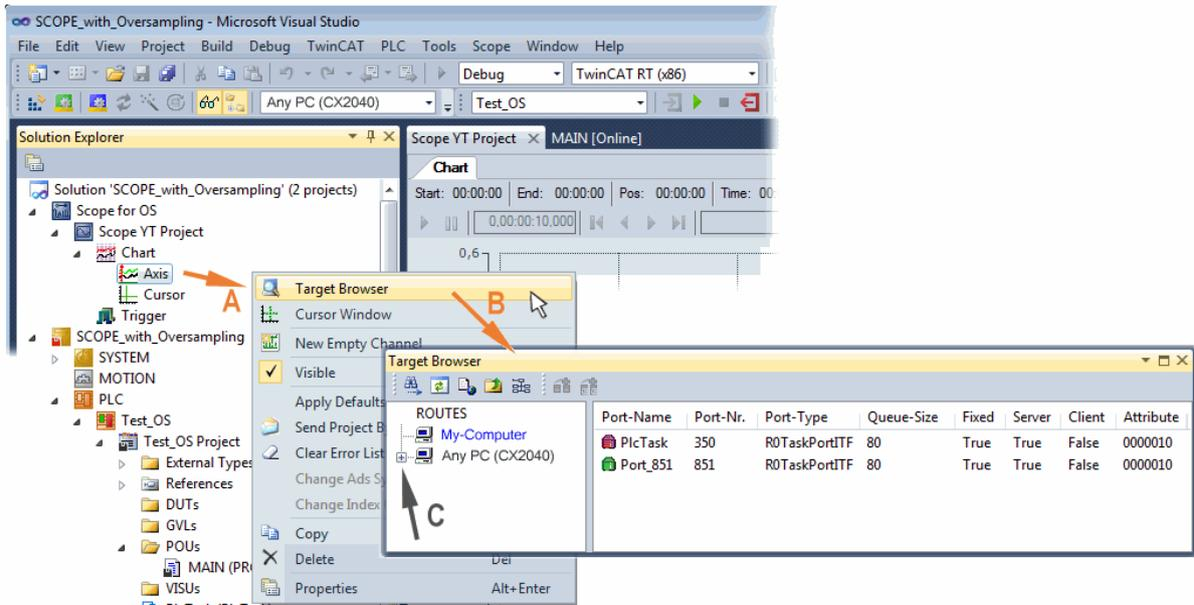
Abb. 142: Auswahl der oversampling - Variablen mit dem "target browser"
