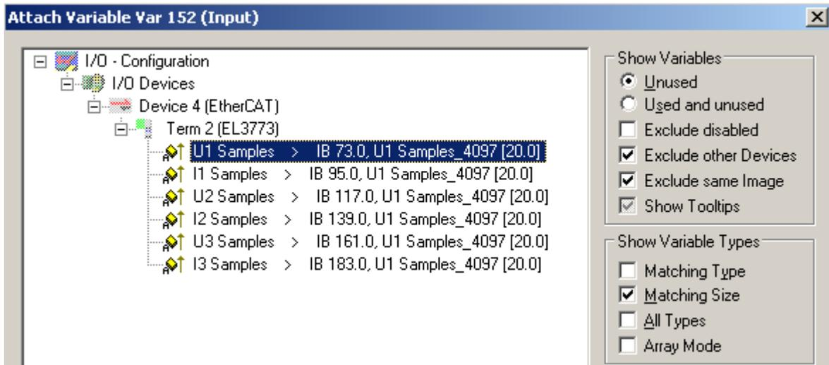
Abb. 153: Array-Variablen einer Oversampling-Klemme
