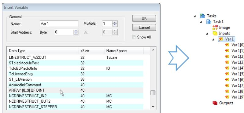
Abb. 139: Einfügen der zum Oversampling passenden Variablen „Var 1“
