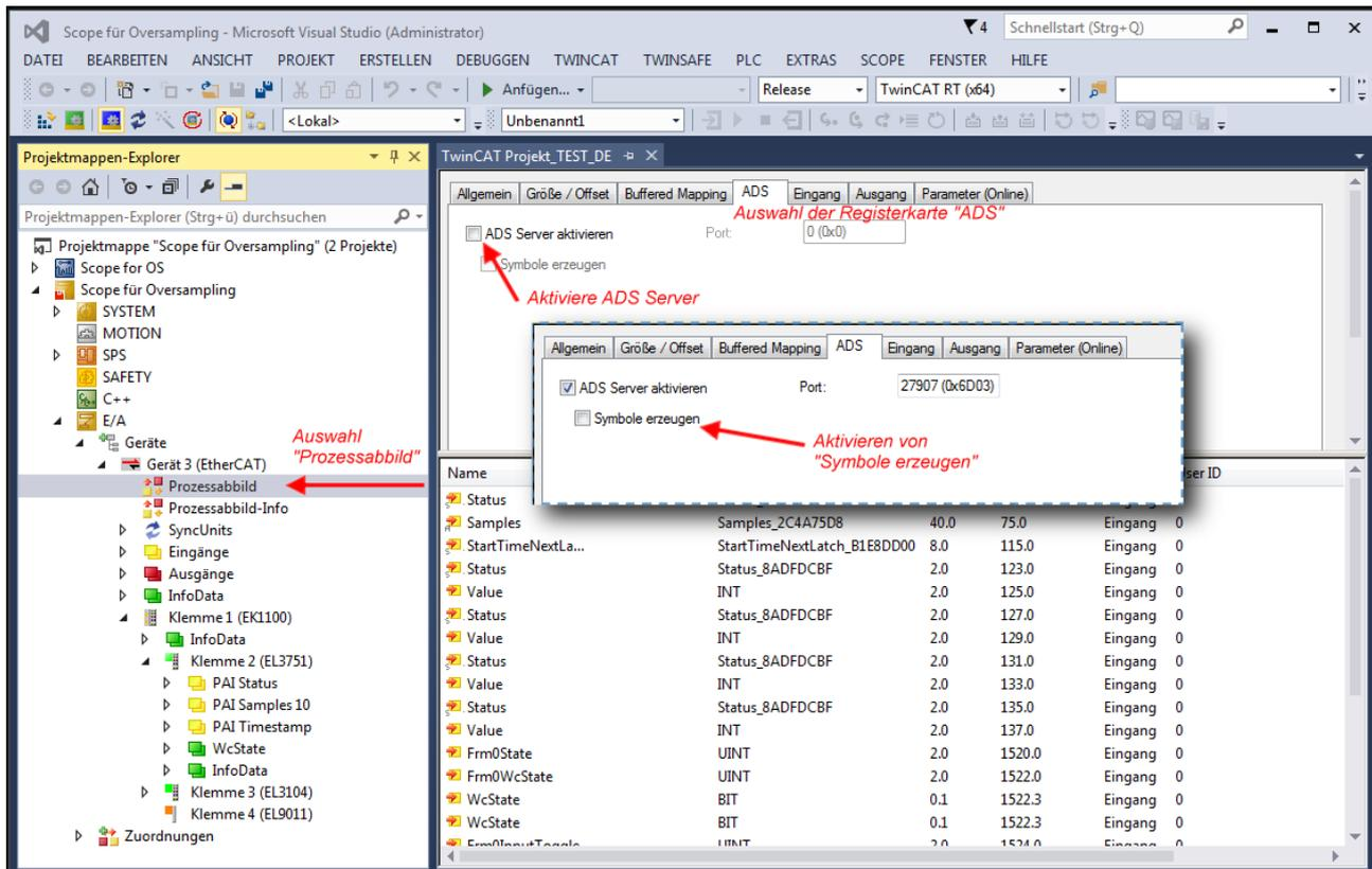
Abb. 145: Aktivierung des ADS Servers des EtherCAT Device (TwinCAT 3)
