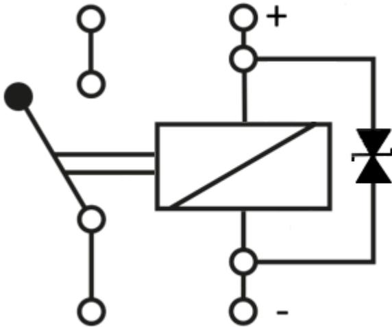
Abb. 13: Beispielschaltung mit bidirektionaler Supressordiode (Transient Voltage Suppressor)
