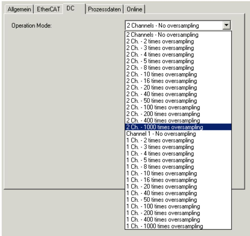
Abb. 163: Auswahldialog Oversamplingfaktoren der EL2262 im TwinCAT SystemManager, Karteireiter "DC"
