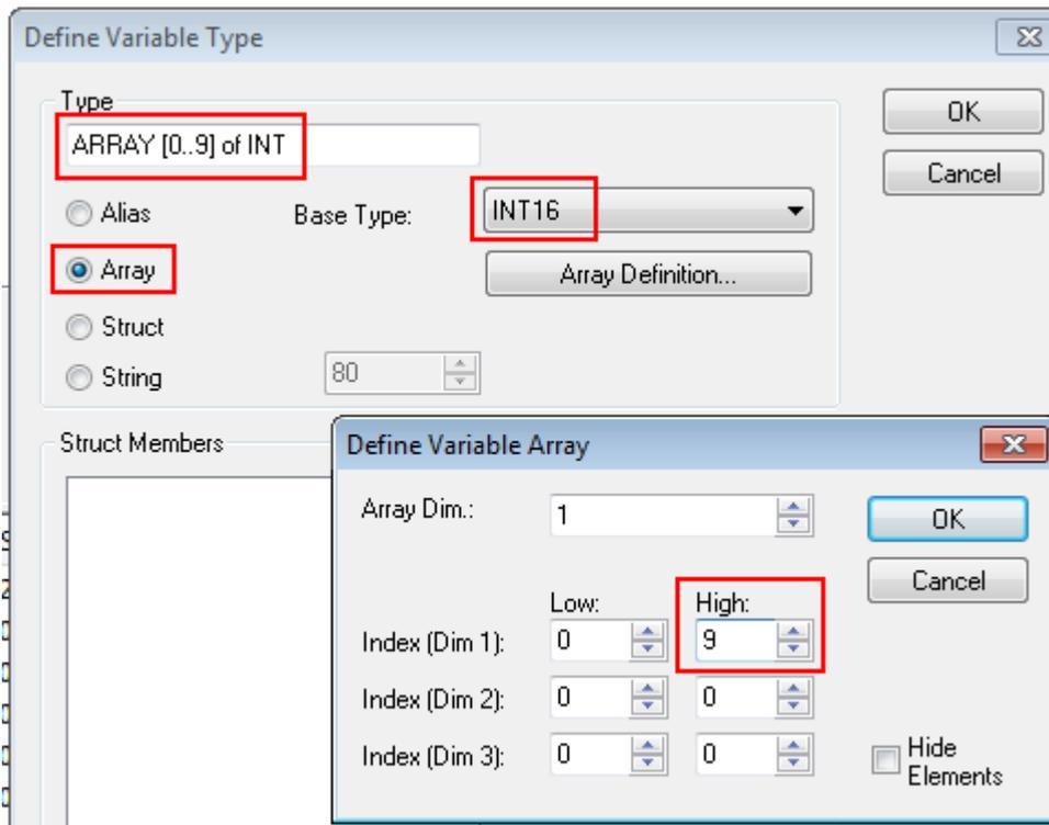
Abb. 150: Definieren des Variablen Typs
