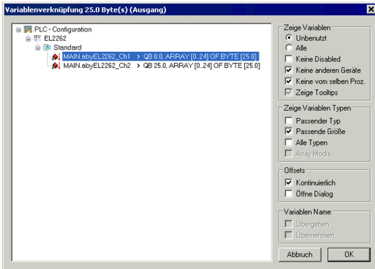
Abb. 171: entsprechende Variablenmenge aus der Task wählen
