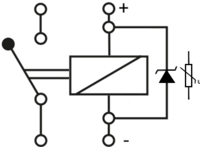
Abb. 12: Beispielschaltung mit Z-Diode
