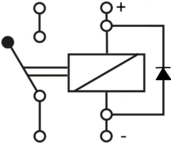
Abb. 11: Kurzschlussdiode an der Induktivität, Freilaufdiode
