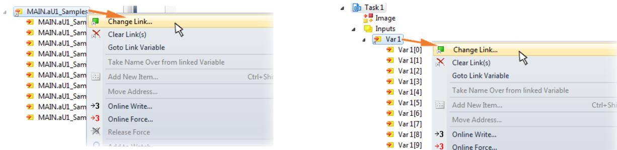
Abb. 140: Setzen der Verknüpfung der PLC Feldvariablen (links: vorhergehender Schritt 2a; rechts: : vorhergehender Schritt 2b)
