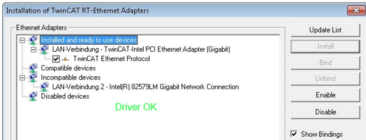
Abb. 73: Beispielhafte korrekte Treiber-Einstellung des Ethernet Ports
