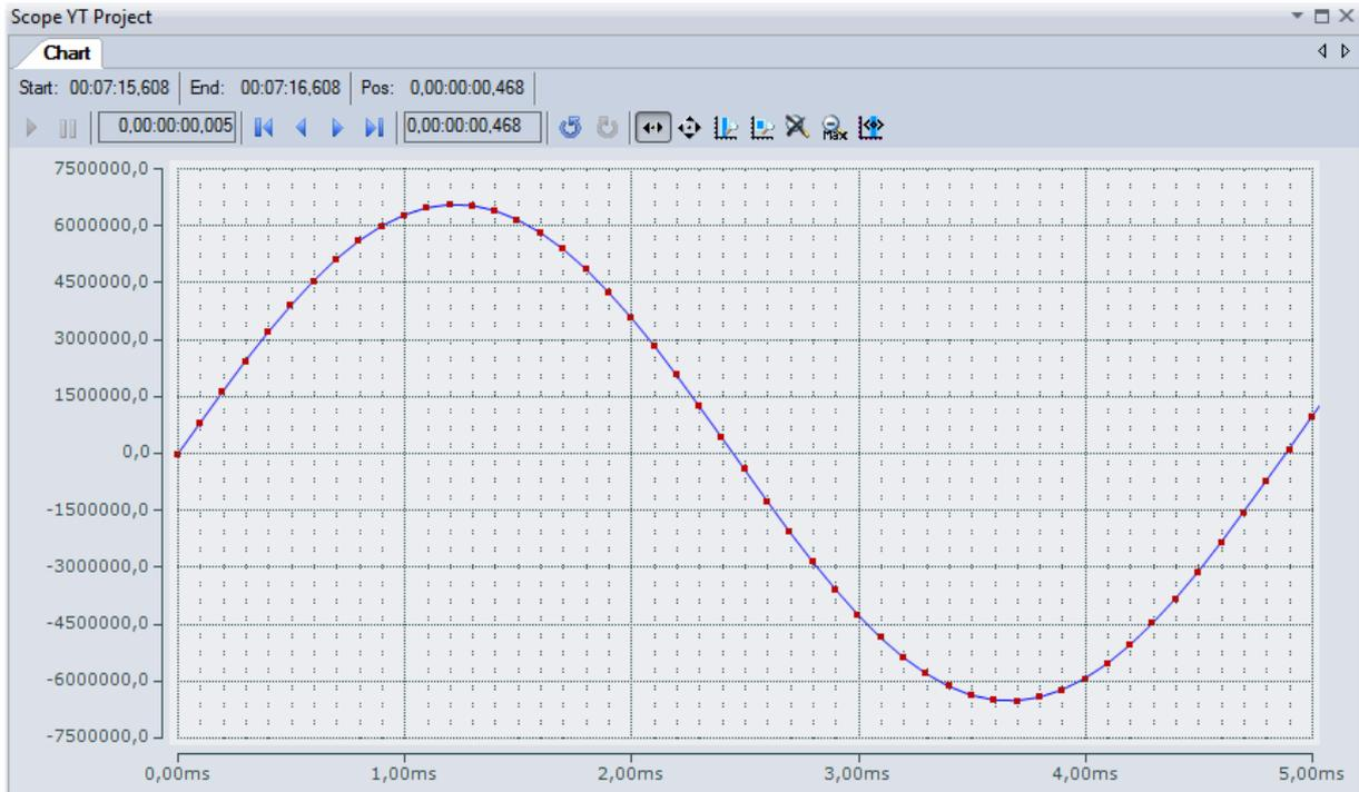
Abb. 144: Beispiel einer Messung eines Sinussignals mit 10 Fach Oversampling bei 1 ms Messzykluszeit
