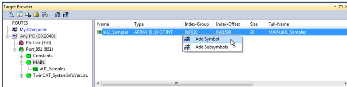
Abb. 143: Hinzufügen der "aUI\_Samples" Feldvariablen zu "Axis" des Scope
