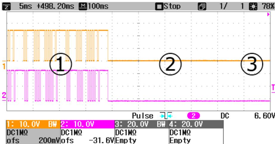
Abb. 167: default Ausgabeverhalten bei aktivierter CycleCounter-Überwachung
