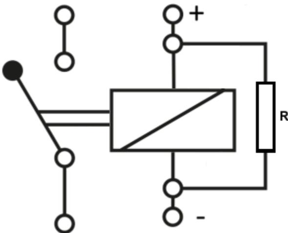
Abb. 10: Widerstand parallel zur Induktivität
