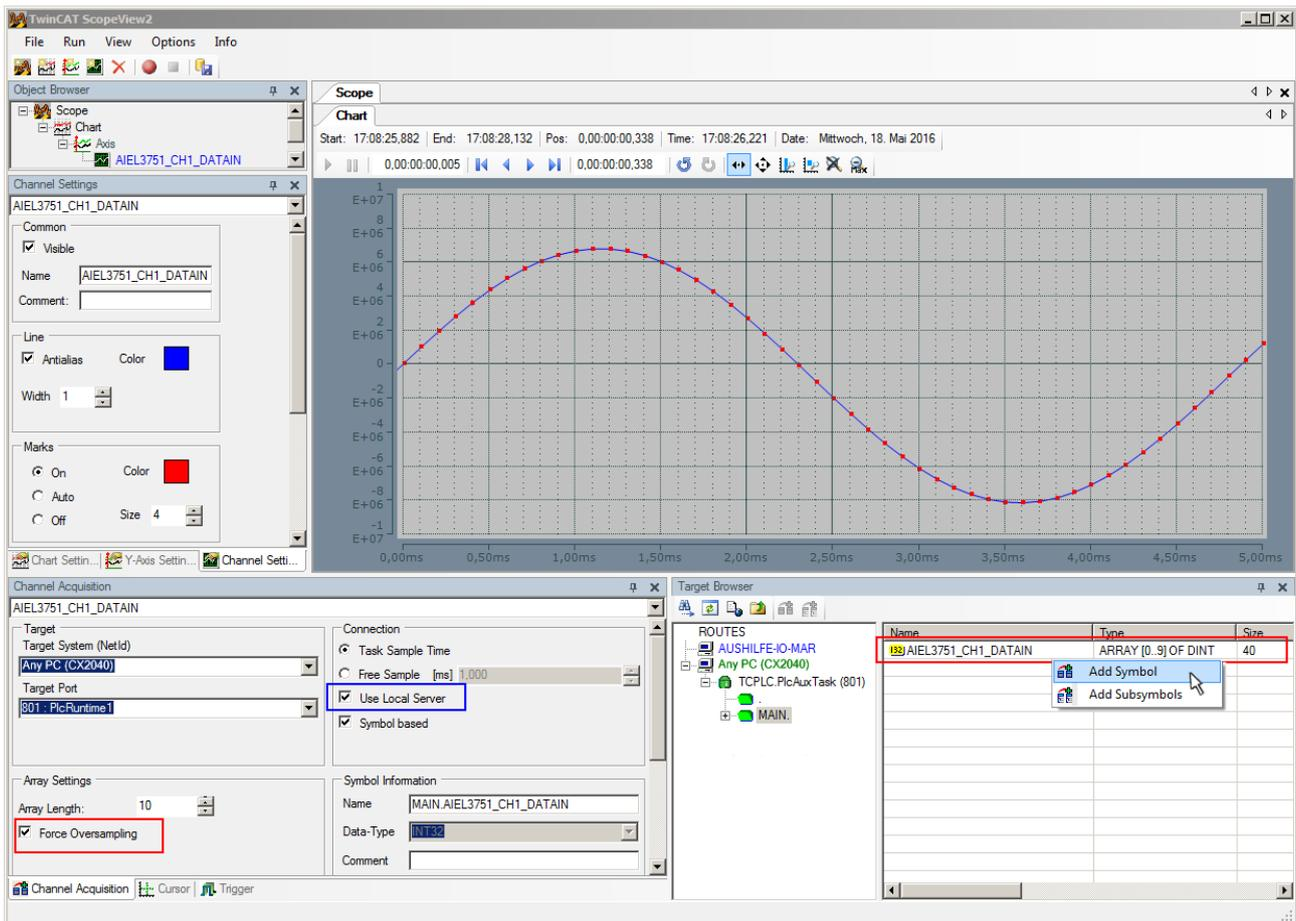
Abb. 159: Darstellung einer 10 x Oversampling-Variablen der EL3751 mit dem Scope2
