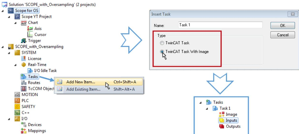
Abb. 137: Einfügen einer "freien" Task
