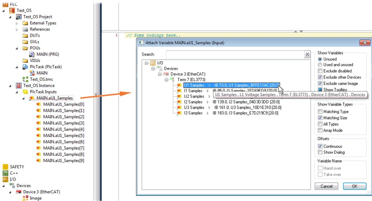
Abb. 141: Auswahl des EL3773 PDO "L1 Voltage Samples" zum Erstellen eines Links mit der PLC Feldvariablen „aUI\_Samples“
