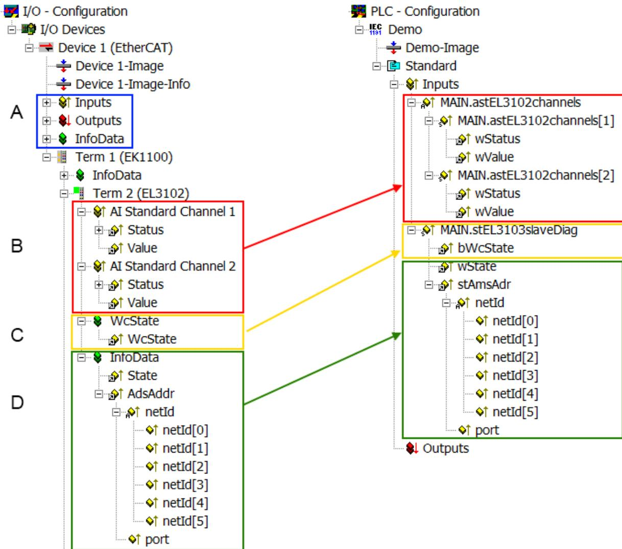
Abb. 126: Grundlegende EtherCAT-Slave Diagnose in der PLC
