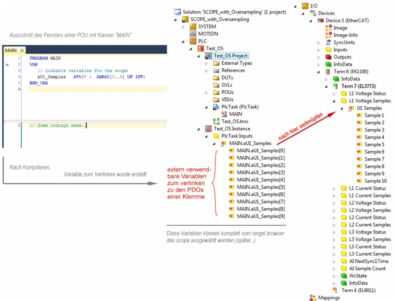
Abb. 136: Darstellung der erstellten PLC Feldvariablen („aUI\_Samples“) zur Verknüpfung mit oversampling PDOs einer EL3773
