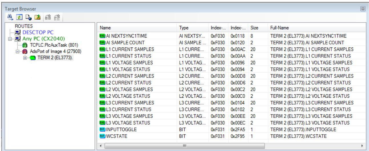
Abb. 161: Direkter Zugriff des Scope2 auf PDOs der Klemme
