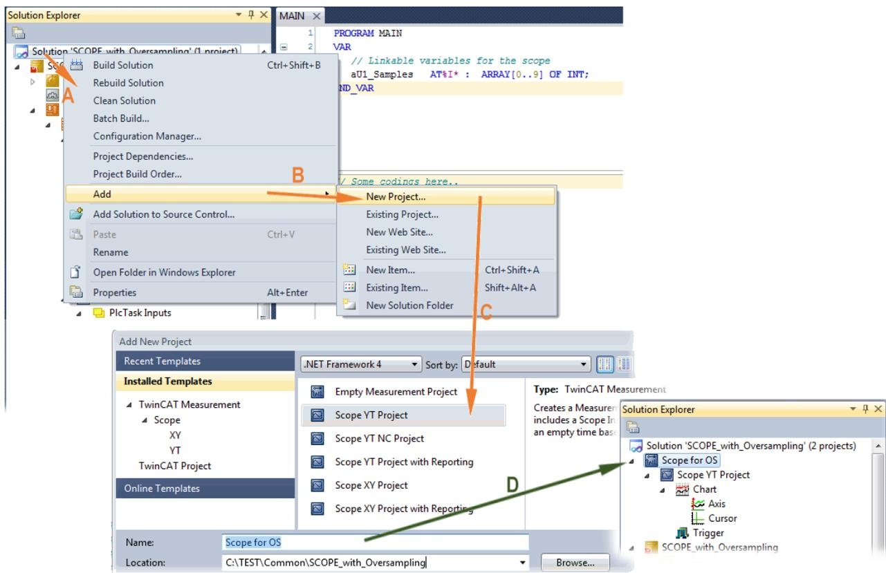
Abb. 135: Hinzufügen eines Scope Projekts zu einem bereits vorhandenen Projekt
