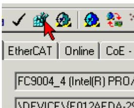
Abb. 175: Aktivierung der Konfiguration
