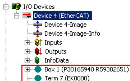
Abb. 108: Fehlerhafte Erkennung
