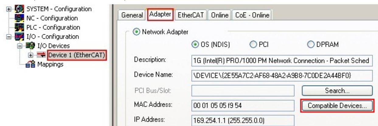
附图 73: EtherCAT 设备属性（TwinCAT 2）：点击“Adapter”选项卡的“Compatible Devices...”
