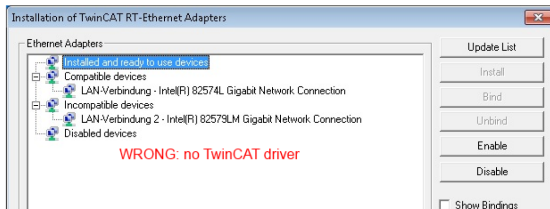
Abb. 75: Fehlerhafte Treiber-Einstellungen des Ethernet Ports
