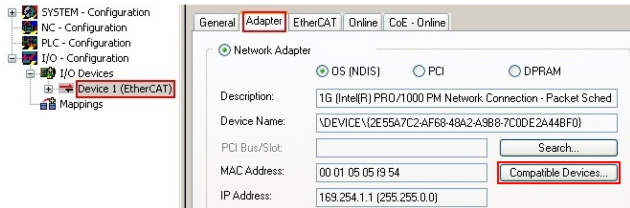
附图 67: EtherCAT 设备属性（TwinCAT 2）：点击“Adapter”选项卡的“Compatible Devices...”
