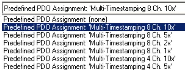
Abb. 158: Einstellung des Multi-Timestamping über „Predefined PDO“
