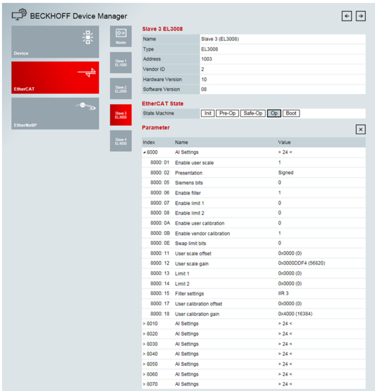
Abb. 20: Konfiguration über HTML-Seiten - Parametrierung der EtherCAT-Klemmen
