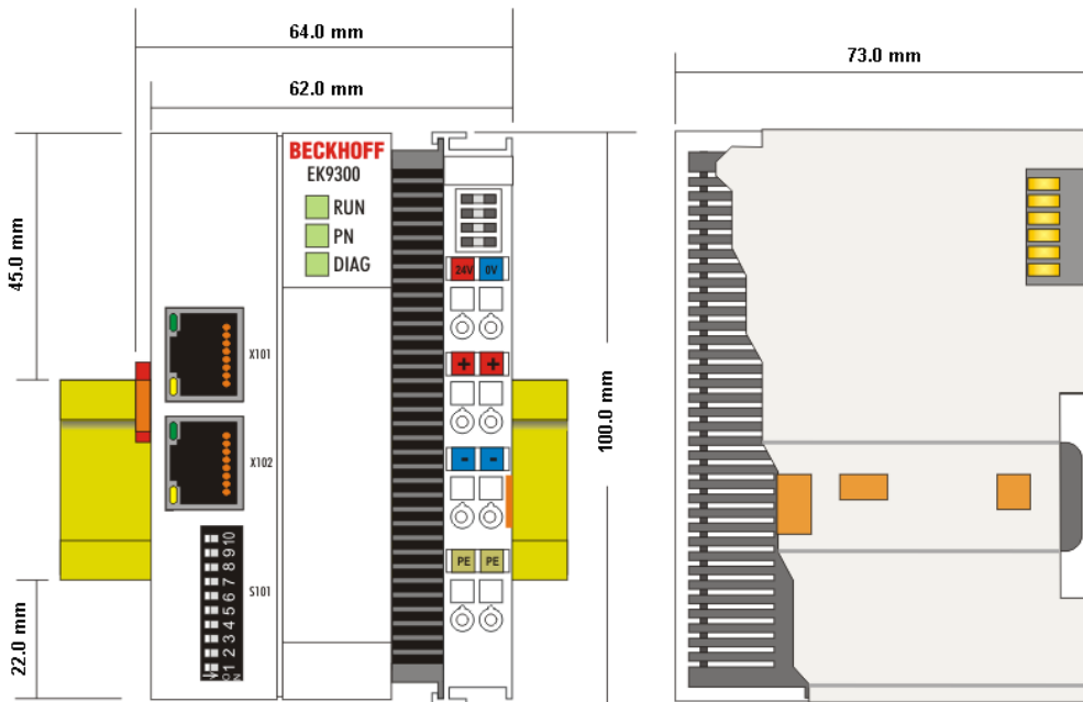
Abb. 7: EK9xxx - Abmessungen am Beispiel EK9300
