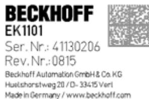
Abb. 1: EK1101 EtherCAT Koppler mit Revision 0815 und Seriennummer 41130206
