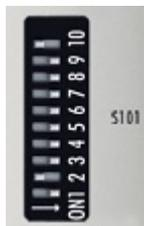
Abb. 14: DIP-Schalter S001: Links off "0", rechts on "1"
