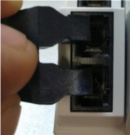
図：使用していないソケットに装着されたブラインドプラグ
