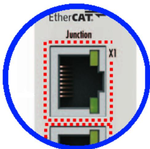
図 10: EK1122-0080およびEK1101-0080での高速ホットコネクポートの識別
