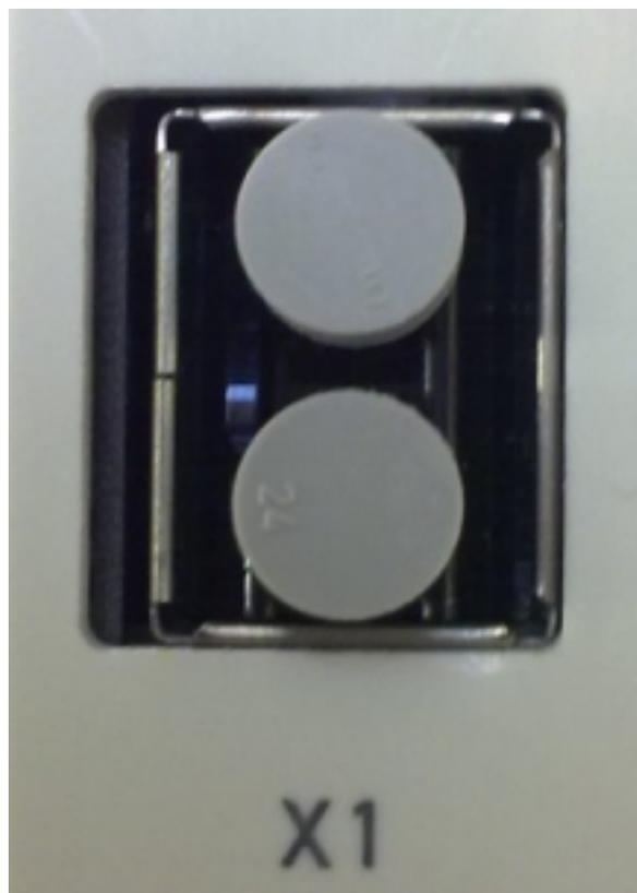
図: 使用していないソケットに装着されたブラインドプラグ
