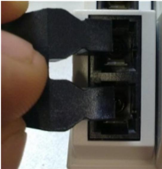
图：空闲插孔上的盲塞
