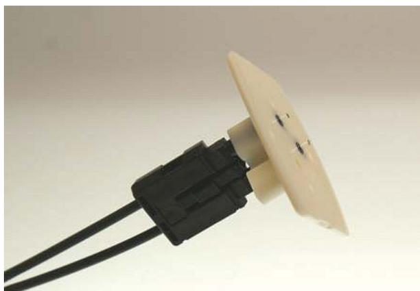
附图 58：带有突出的光纤末端的打磨尺
