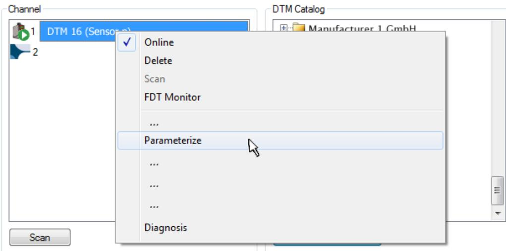
Abb. 160: Kontextmenü eines DTM Sensors/ Aktors „online“
