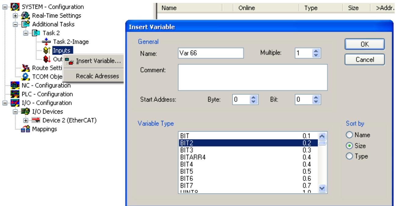
Abb. 142: Verlinkung 2-Bit-Variable mit zusätzlicher Task
