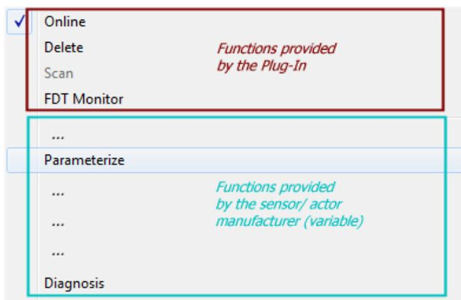
Abb. 161: Aufteilung des „online“ – Kontextmenüs eines DTM Sensors/ Aktors über das FDT Plug-In
