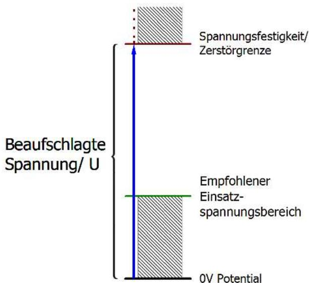
Abb. 27: Empfohlener Einsatzspannungsbereich
