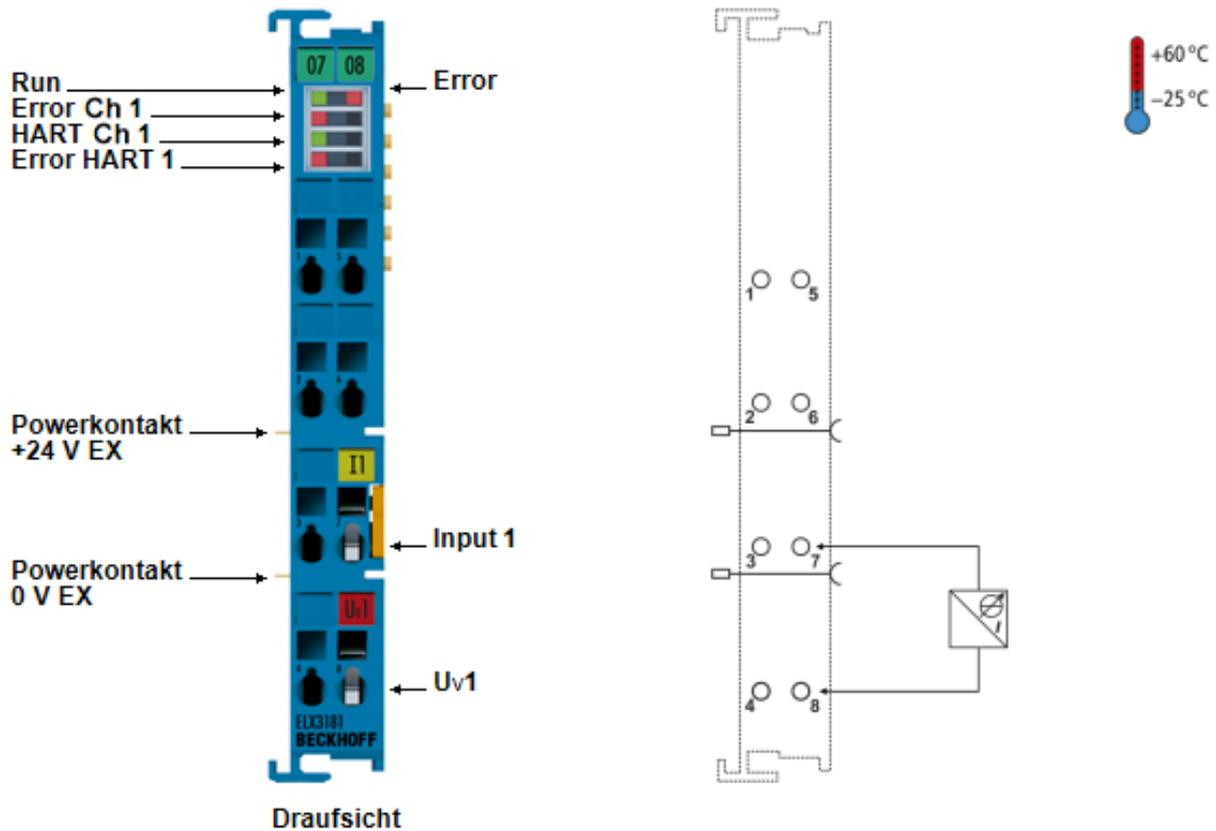
Abb. 21: ELX3181 - Anschlussbelegung
