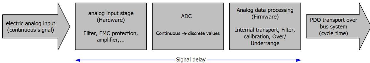
Abb. 28: Signalverarbeitung Analogeingang
