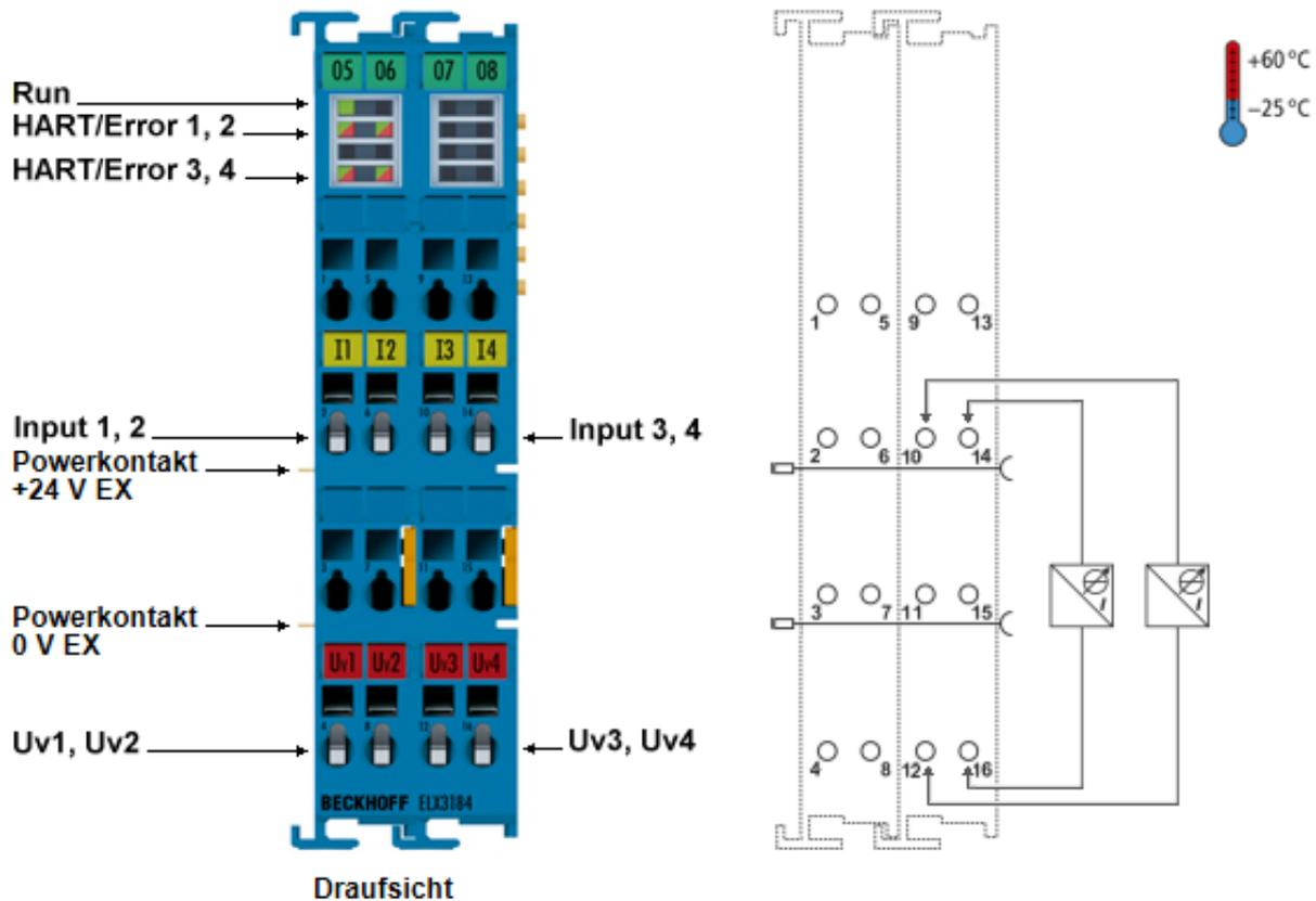
Abb. 5: ELX3184 - Vierkanalige Analog-Eingangsklemme, 4...20 mA, single-ended, 16 Bit, HART, Ex i
