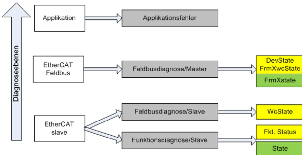
Abb. 131: Auswahl an Diagnoseinformationen eines EtherCAT Slaves
