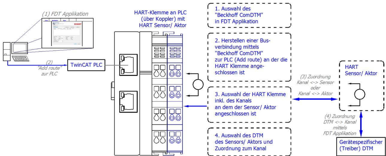
Abb. 166: Vorgehensweise mit der FDT-Applikation für HART-DTM Zugriff über die Beckhoff\_ComDTM
