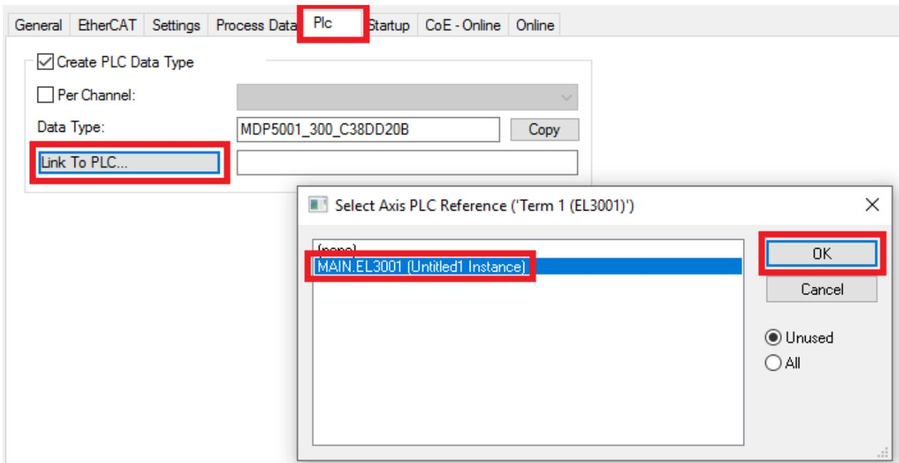
Abb. 71: Verknüpfung der Struktur
