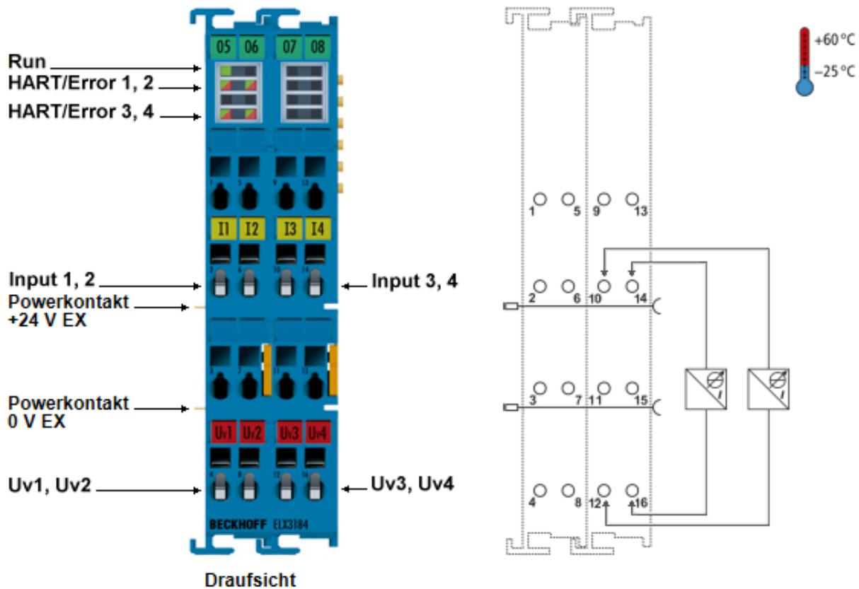
Abb. 22: ELX3184 - Anschlussbelegung
