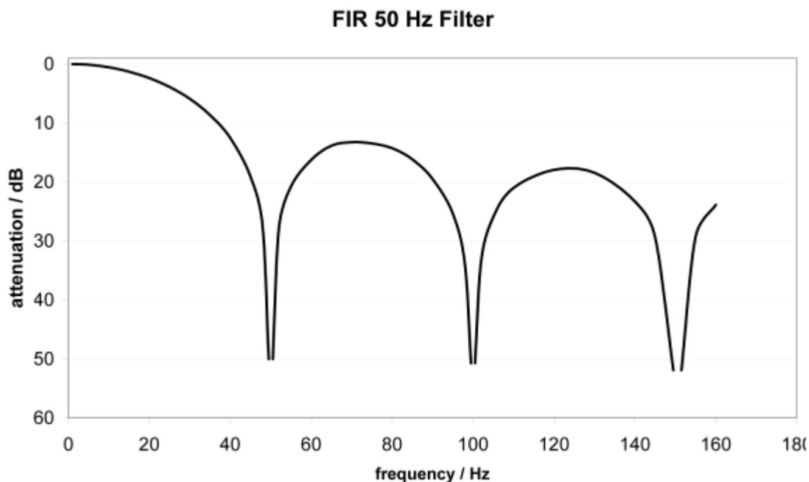
Abb. 144: Dämpfungskurve Notch.Filter bei 50 Hz
