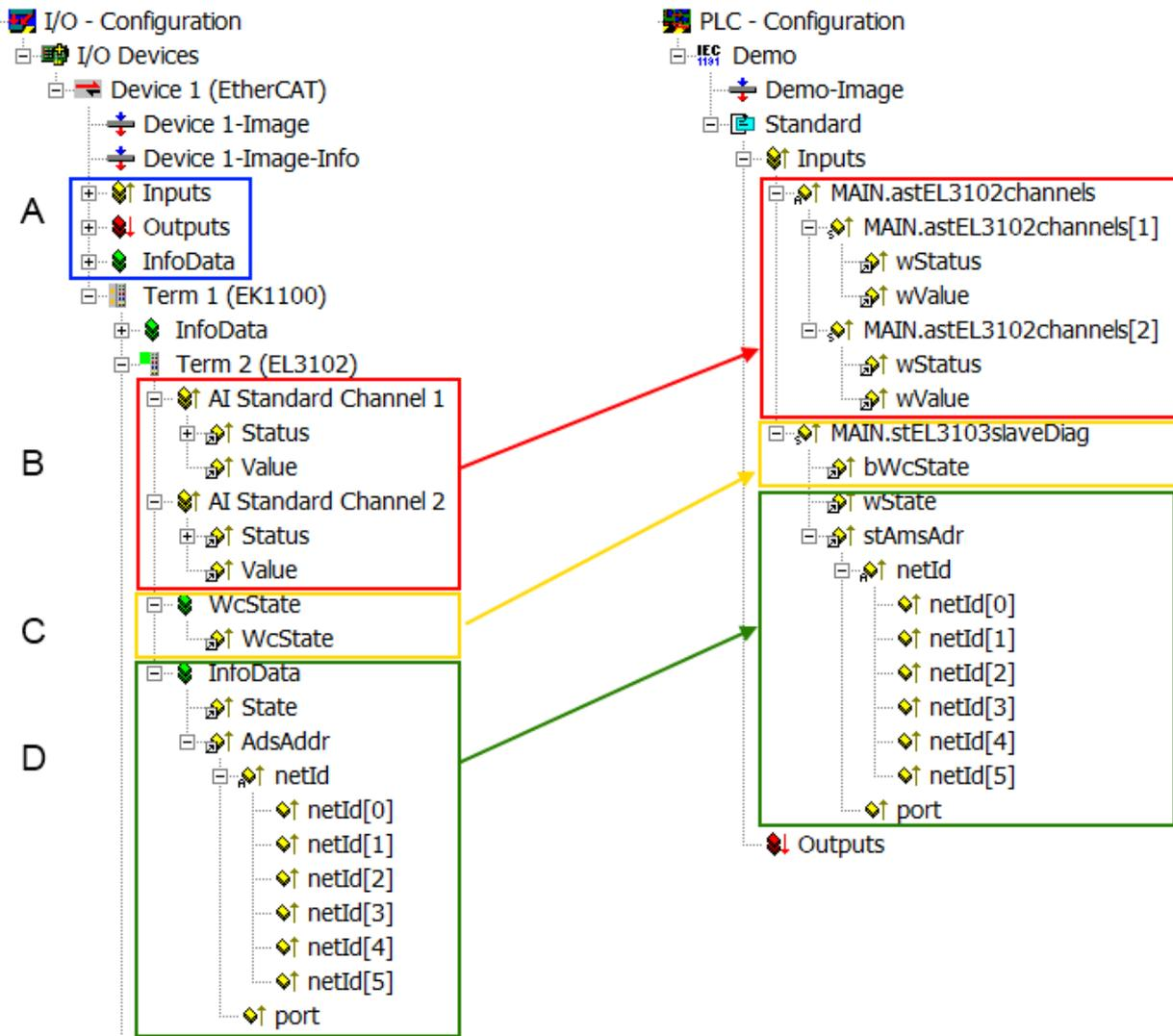
Abb. 132: Grundlegende EtherCAT Slave Diagnose in der PLC
