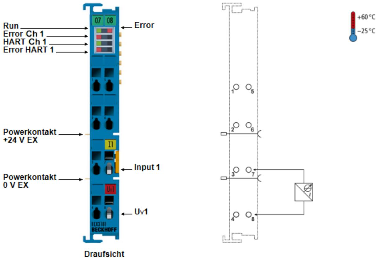
Abb. 4: ELX3181 - Einkanalige Analog-Eingangsklemme, 4...20 mA, single-ended, 16 Bit, HART, Ex i
