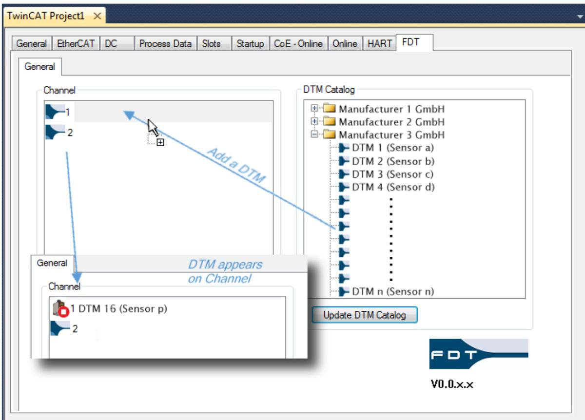
Abb. 157: Hinzufügen eines Sensor/AktorDTM Gerätetreibers zum zugehörigen Kanal einer Klemme/ Box
