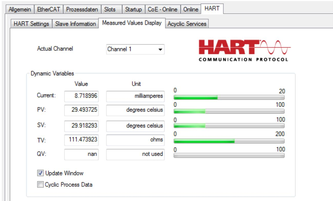
Abb. 154: Anzeige der über HART ausgelesenen Werte
