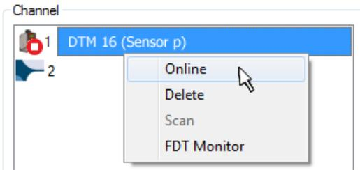
Abb. 159: Kontextmenü eines DTM Sensors/ Aktors „offline“
