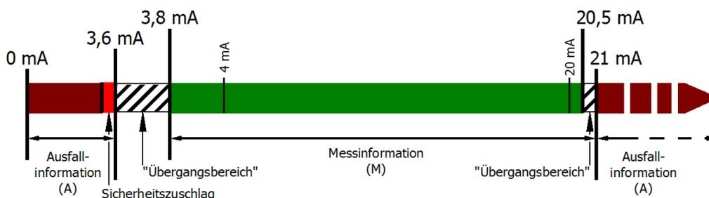
Abb. 31: Darstellung der Grenzbereiche aus der NAMUR-Empfehlung NE43, Version 03.02.2003
