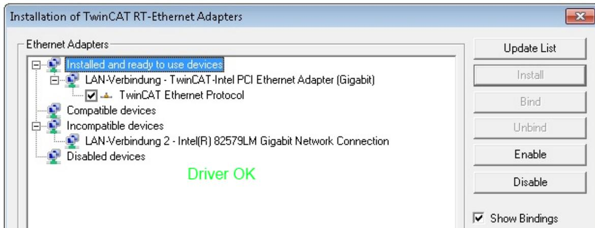
Abb. 79: Beispielhafte korrekte Treiber-Einstellung des Ethernet Ports
