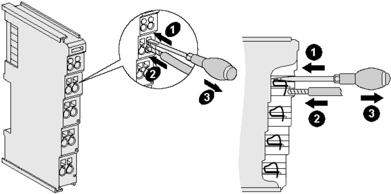
Abb. 20: Anschluss einer Leitung an eine Klemmstelle
