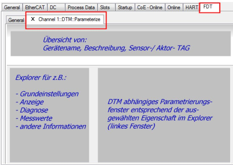
Abb. 158: Allgemeiner Aufbau eines DTM-Konfigurationsfensters innerhalb des Field Device Tools (FDT)
