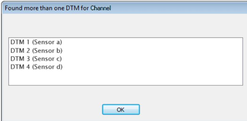
Abb. 162: Ergebnis nach einem DTM - "Scan" über das FDT-Plug-In in TwinCAT
