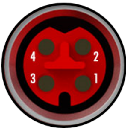
Abb. 23: Pinbelegung M8, EtherCAT P In und EtherCAT P Out
