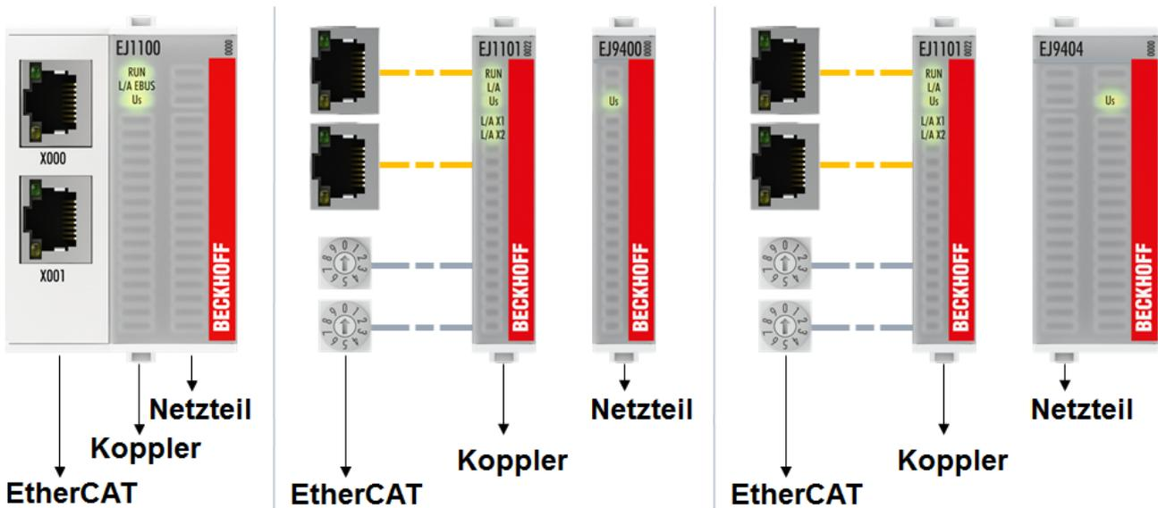
Abb. 12: E-Bus-Spannungsversorgung mit EJ1100 oder EJ1101-0022 + EJ940x
