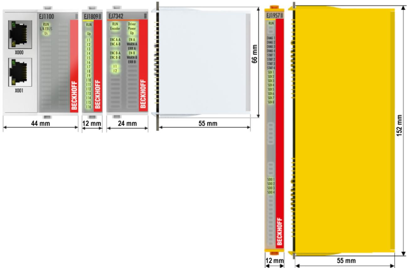
Abb. 14: EJxxxx - Abmessungen
