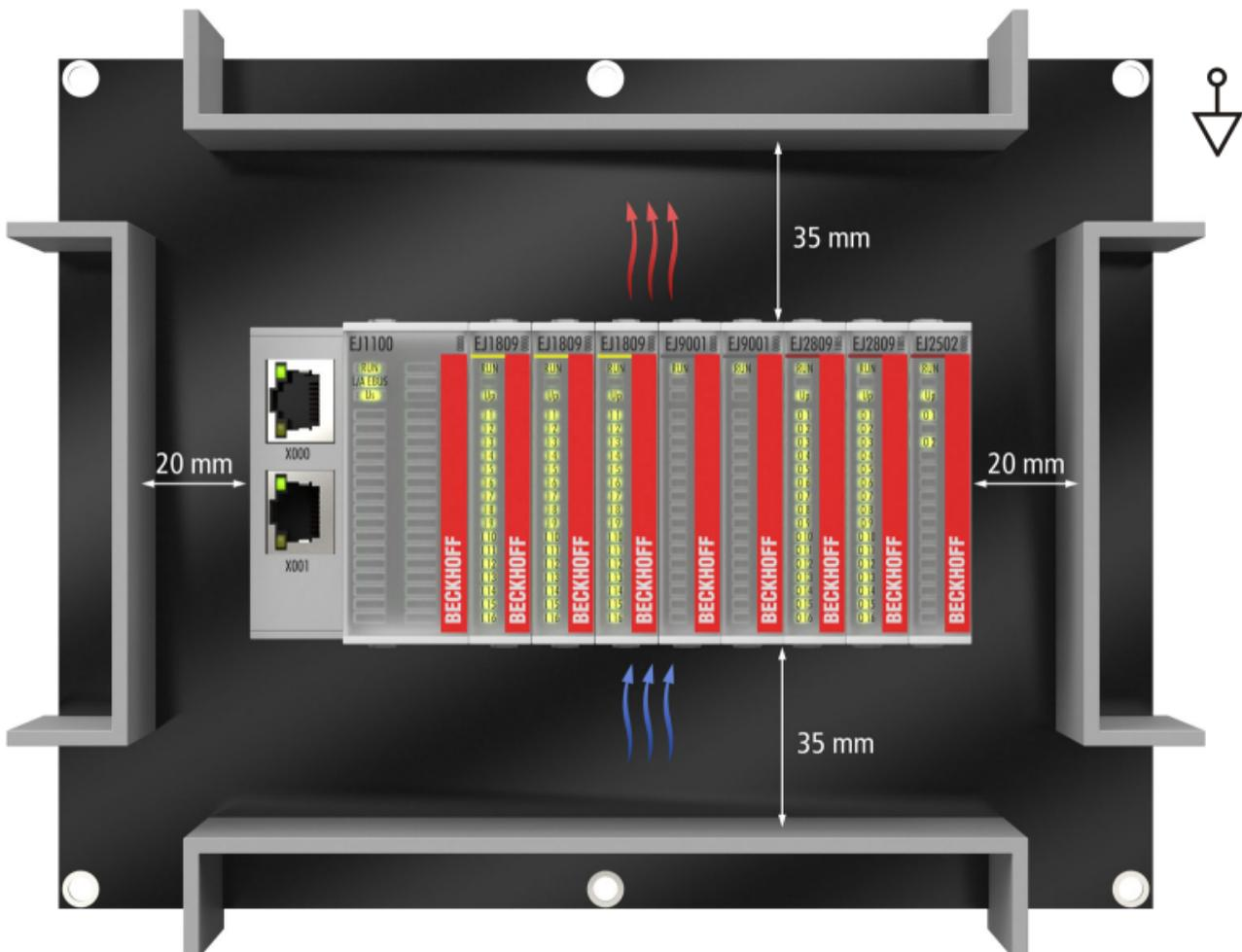
Abb. 17: Empfohlene Abstände bei Standard Einbaulage
