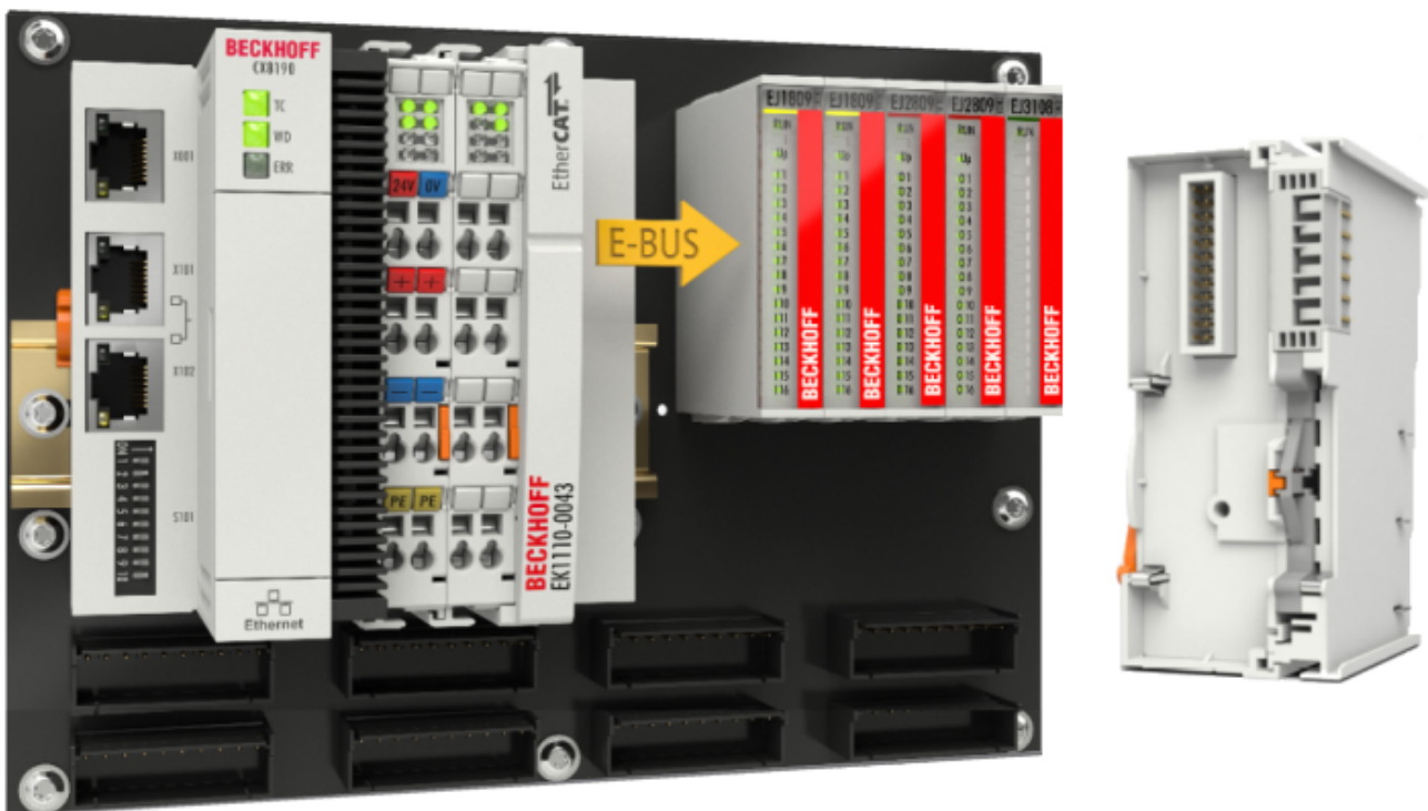
Abb. 11: Leiterkarte mit Embedded PC, EK1110-0043 und EJxxxx, Rückansicht EK1110-0043
