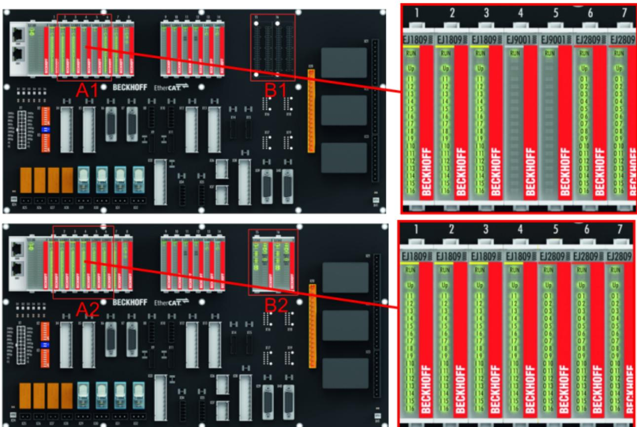
Abb. 21: Beispiel Austausch Platzhaltermodule u. Belegung Reserveslots
