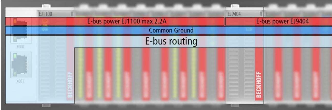
Abb. 9: Beispiel mit EJ1100 Koppler mit integriertem Netzteil (2,2 A), Auffrischung mit EJ9404 (12 A)
