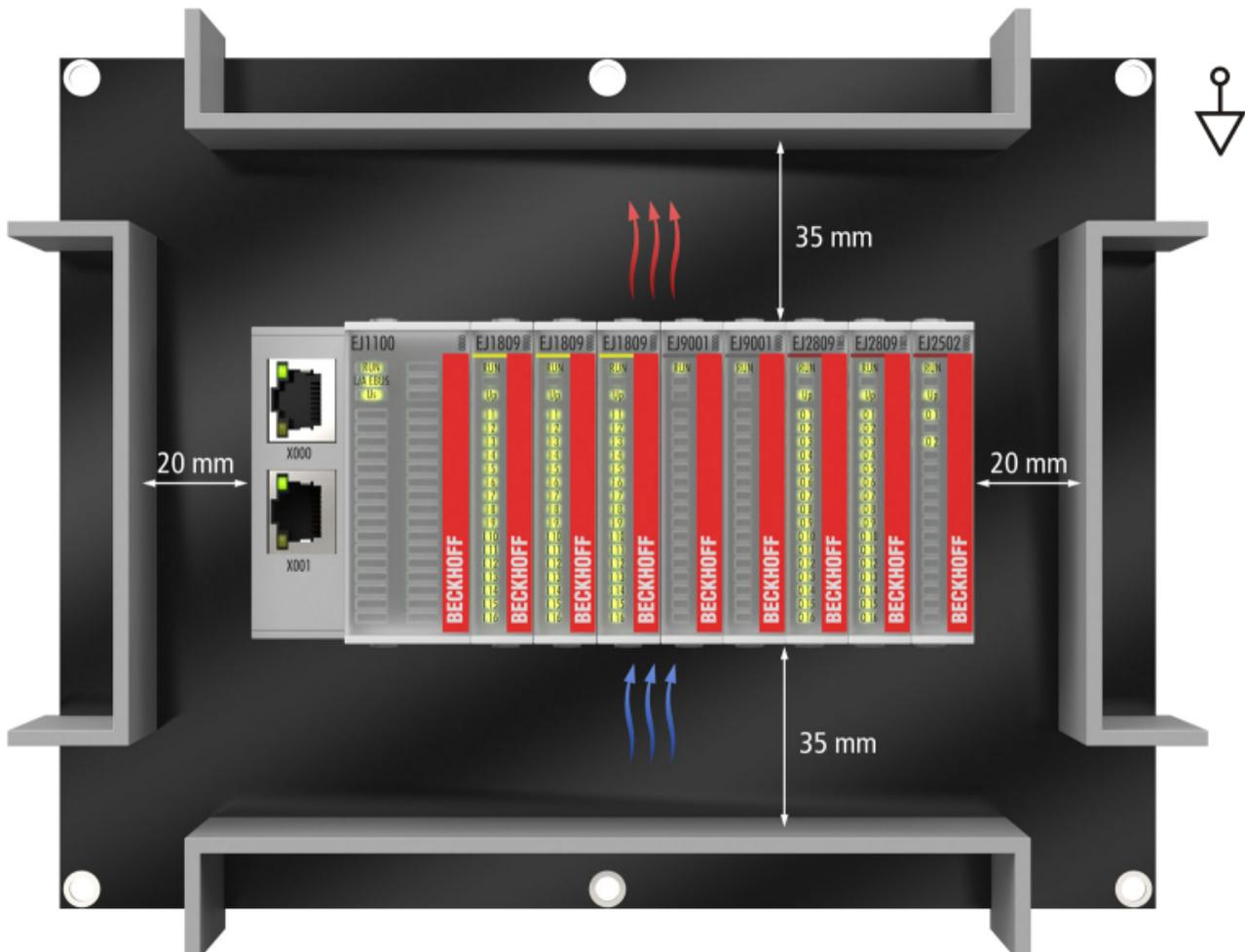
Abb. 17: Empfohlene Abstände bei Standard Einbaulage
