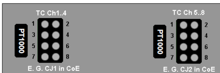
Abb. 13: Routing der TCs zu zwei verschiedenen TC-Steckern am Beispiel EJ3318
