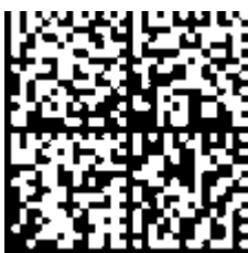
Abb. 4: Beispiel-DMC 1 P072222 S BTNk4p562d7 1 KEL1809 Q 1 51 S678294
