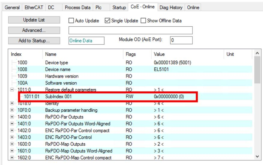
Fig. 40: Selecting the Restore default parameters PDO
