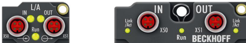
Abb. 4: Steckverbinder für EtherCAT P
