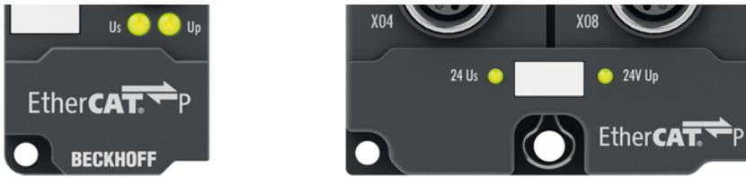
EtherCAT P-Box-Module zeigen den Status der Versorgungsspannungen über zwei Status-LEDs an. Die Status-LEDs sind mit den Bezeichnungen der Versorgungsspannungen beschriftet: Us und Up.
