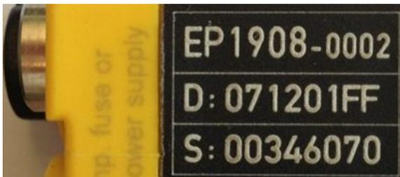
Abb. 52: EP1908-0002 IP67 EtherCAT Safety Box mit Chargennummer/ DateCode 071201FF und eindeutiger Seriennummer 00346070
