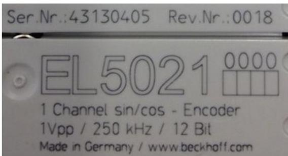
Abb. 47: EL5021 EL-Klemme, Standard IP20-IO-Gerät mit Seriennummer/ Chargennummer und Revisionskennzeichnung (seit 2014/01)
