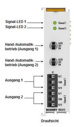
Zweikanalige Relaismodule mit Hand- und Automatikbedienung, 230 V<sub>AC</sub>, 6 A
