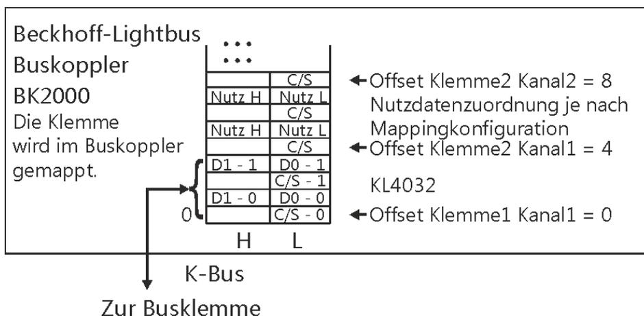
Abb. 13: Mapping im Lightbus-Koppler - Beispiel für KL4032
