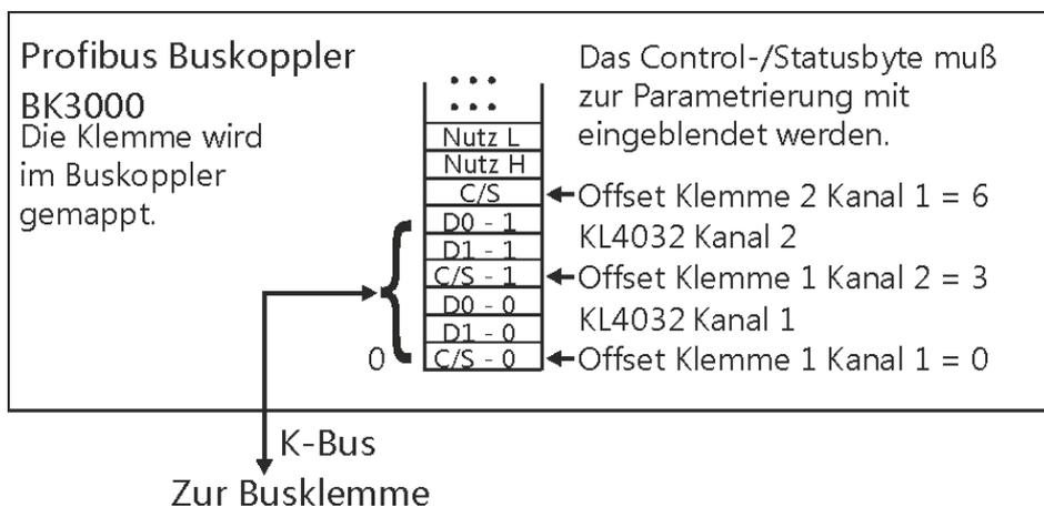
Abb. 14: Mapping im Profibus-Koppler - Beispiel für KL4032
