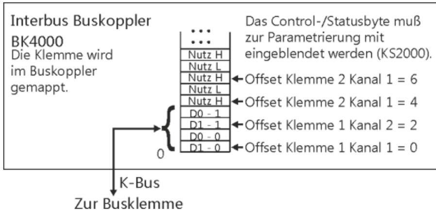
Abb. 15: Mapping im Interbus-Koppler - Beispiel für KL4032
