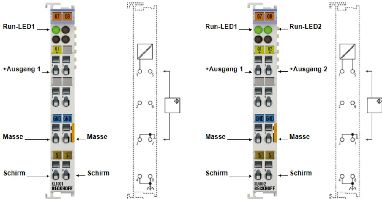
Abb. 11: KL4001, KL4002 - Anschluss und LEDs
