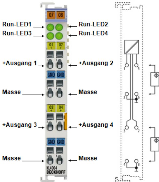
Abb. 12: KL4004 - Anschluss und LEDs
