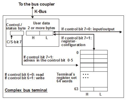
Fig. 18: Register mode control byte
