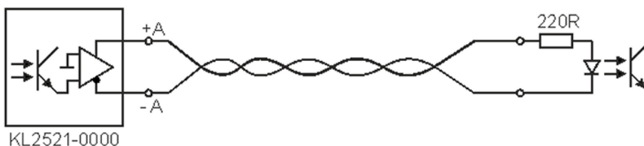
Abb. 14: KL2521-0000 - direkter Anschluss an einem Optokoppler
