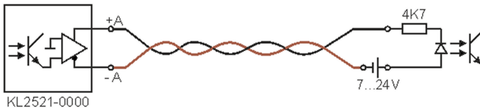
Abb. 15: KL2521-0000 bis Hardware 03 - Beschaltung mit externer Stromquelle
