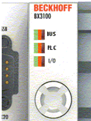
Abb. 125: Diagnose LEDs für die SPS und den K-Bus
