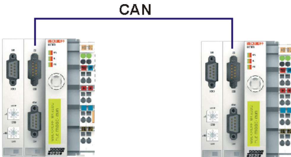
Abb. 59: Kommunikation von BX-Controller zu BX-Controller (über SSB)
