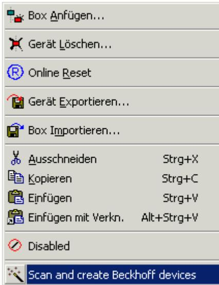
Abb. 19: Einlesen der angeschlossenen Buskoppler und Busklemmen
