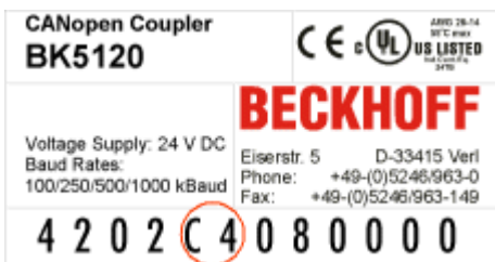
Abb. 36: Angabe des Firmware-Standes auf einem Buskoppler
