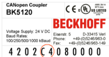
Abb. 32: Angabe des Firmware-Standes auf dem CANopen-Koppler BK5120
