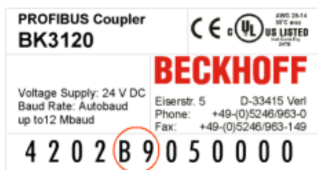
Abb. 31: Angabe des Firmware-Standes auf dem PROFIBUS-Koppler BK3120
